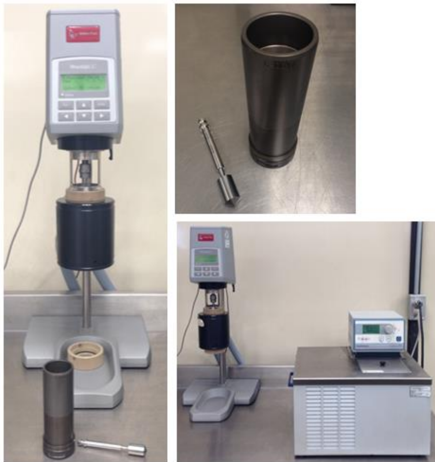
Figura 3.3 - Ensayo de viscosidad rotacional
