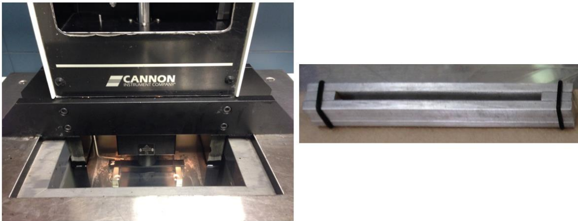
Figura 3.8 - Ensayo de viga a flexión
