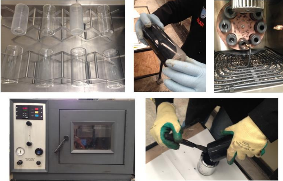
Figura 3.5 - Ensayo de envejecimiento en RTFO
