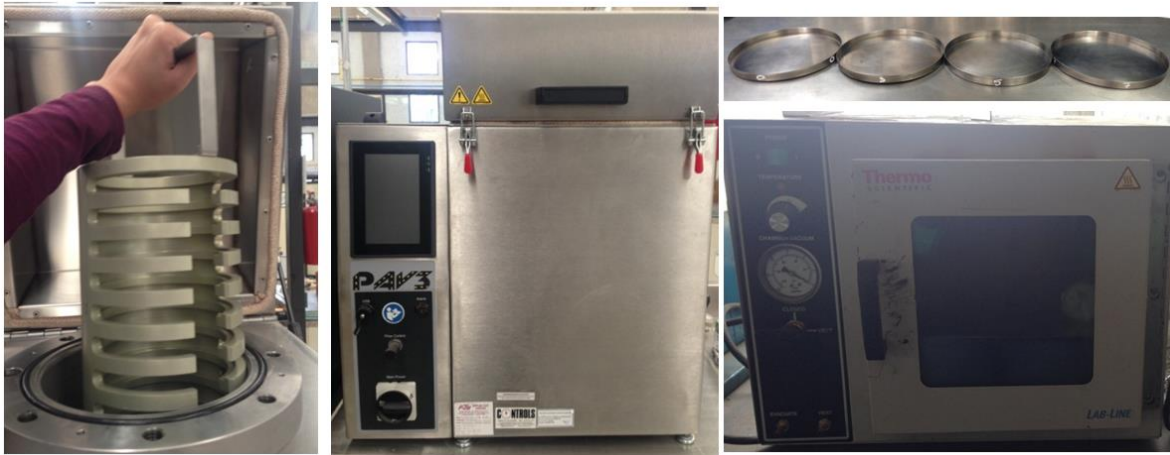
Figura 3.6 - Ensayo de envejecimiento en PAV
