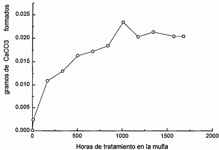
Figura III.40 Gráfico de la cantidad de \text{CaCO}_3 formado con el transcurso del tiempo en las muestras envejecidas en el laboratorio.
