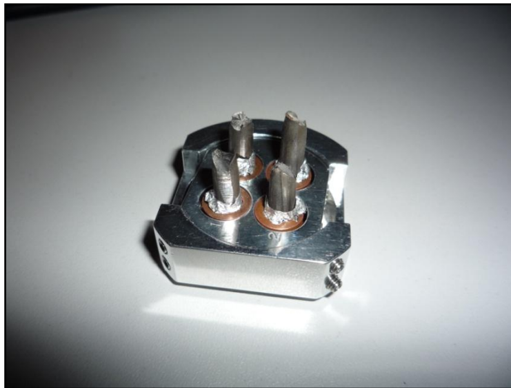
Figura 3.17 probetas montadas en la base y portaprobetas
