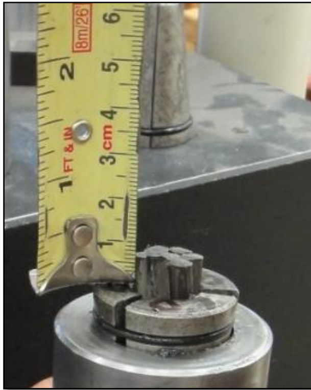
Figura 3.6 Montaje del torón en el sistema de anclaje.
