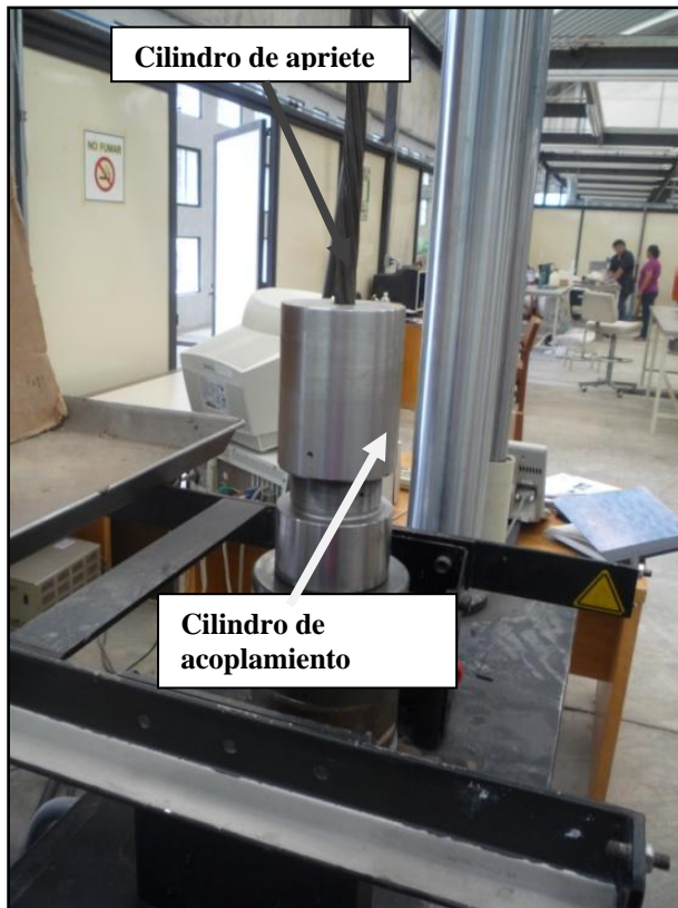
Figura 3.7 Montaje del dispositivo en la máquina servo hidráulica Instron
