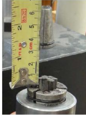
Figura 8.- Montaje del torón en el sistema de anclaje.
