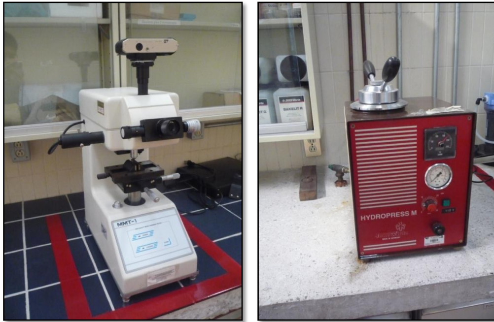
Figura 3.11 Equipo utilizado para las pruebas de microdureza.
