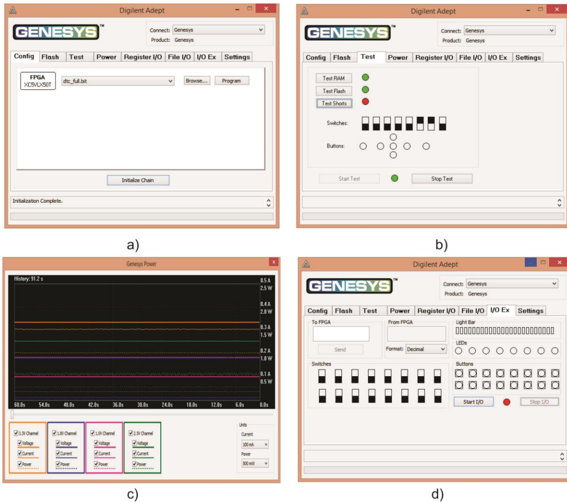
Figura III.47 Pantallas de la aplicación ADEPT para: a) carga de archivo al FPGA, b) prueba de periféricos, c) monitoreo de voltajes y corriente, d) interruptores y LEDs virtuales.
