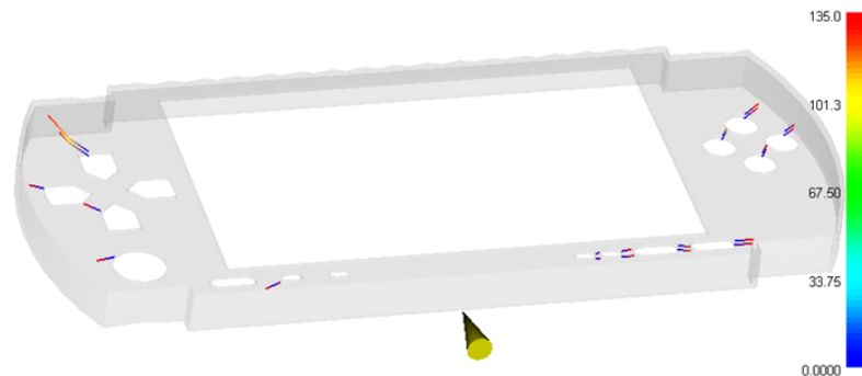
Figura 4.14 Líneas de soldadura en la pieza.
