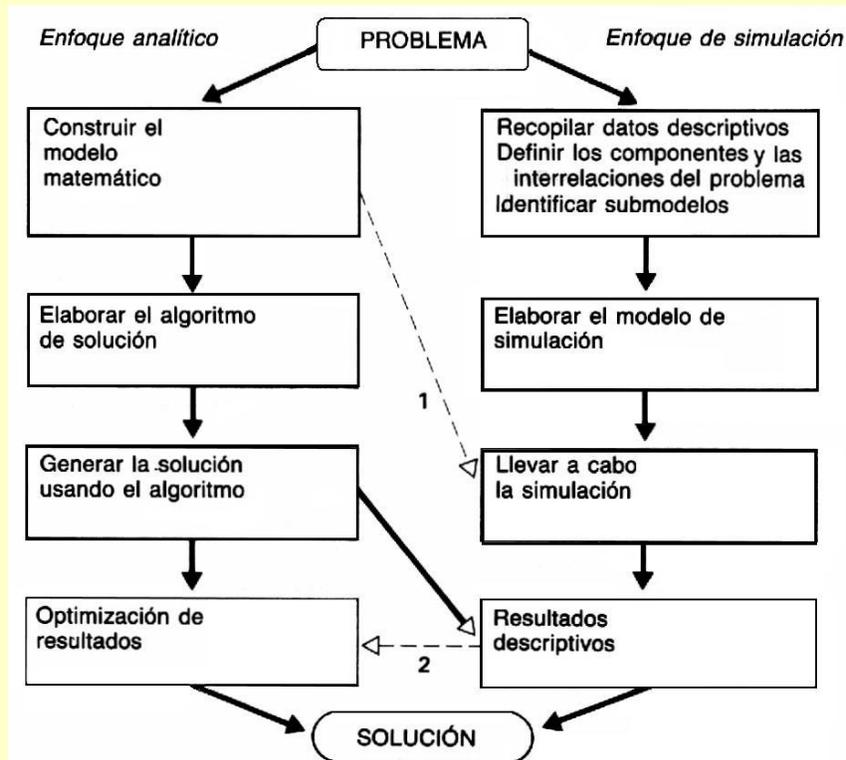
Figura 7.1 Comparación de los métodos de simulación y analítico en el proceso solución de modelos.
