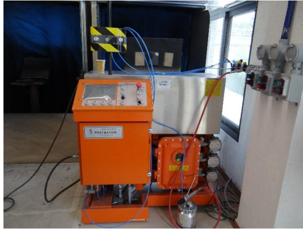
Figura 43. Área de aplicación del laboratorio Mankiewicz: suministro de aire, cabinas de aplicación y equipo de aplicación automática.
