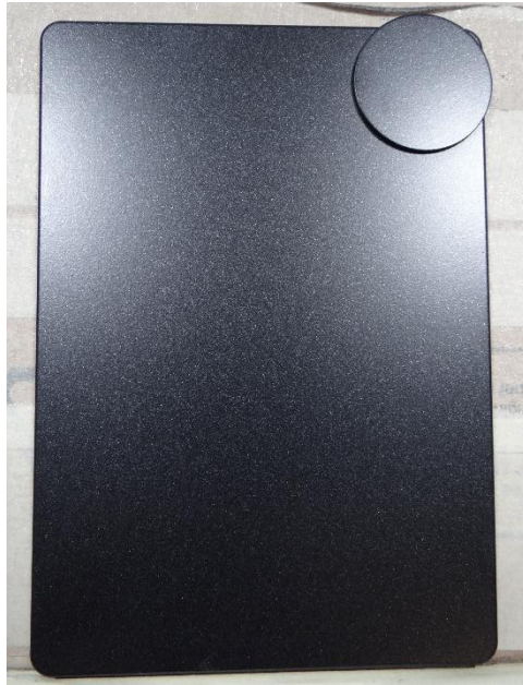
Figura 12. Placa de ABS con recubrimiento Carbon Black bajo luz D65, luz del día.
