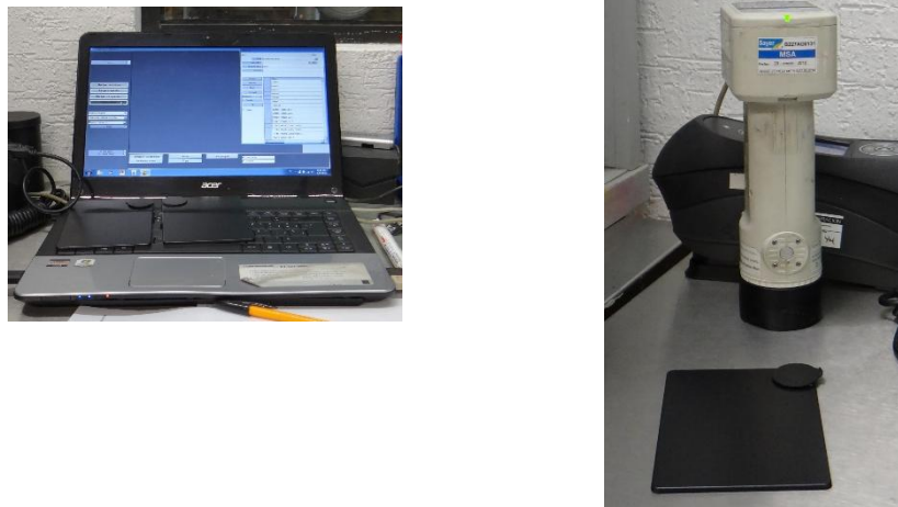
Figura 19. Equipo utilizado para la medición de color: Software de medición, espectrofotómetro portátil Konica Minolta Cm600-D y placa de ABS con pintura aplicada.
