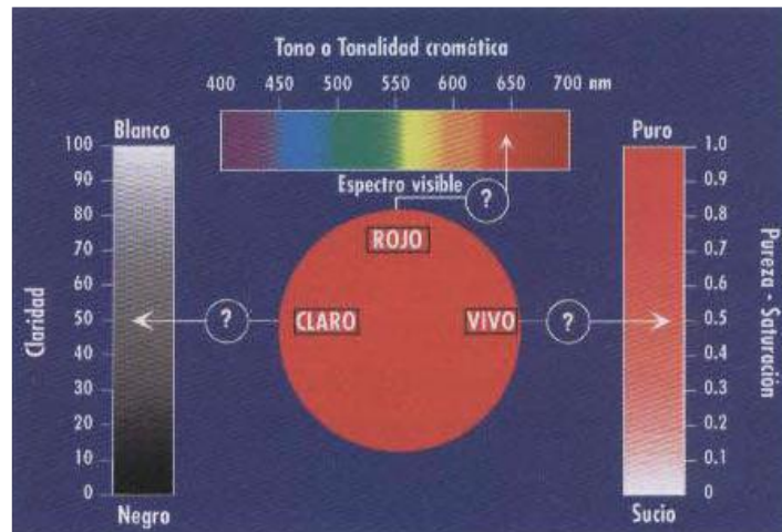
Figura 5. Los 3 factores de percepción visual: tono/ tonalidad cromática (rojo) - saturación /pureza (vivo) - claridad (claro).
