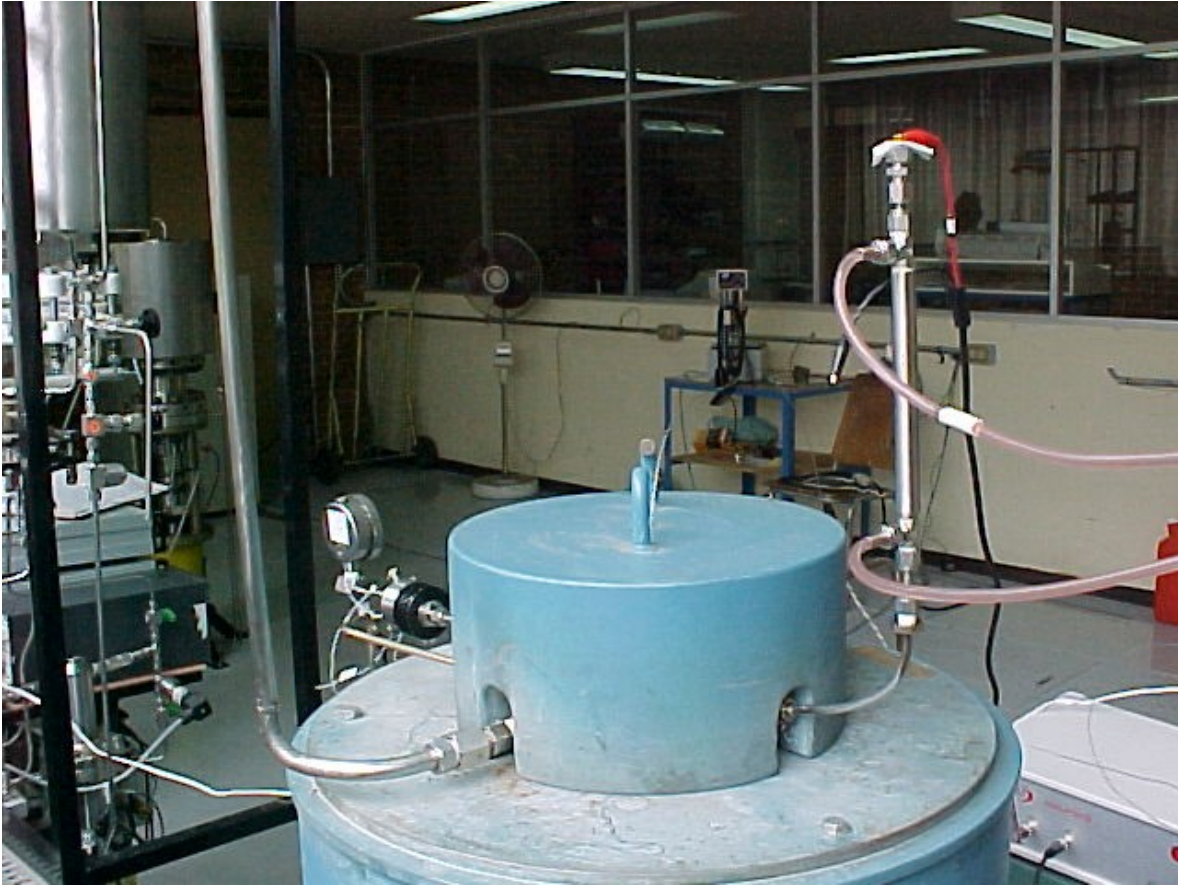
Figura. 2.11 Acoplamiento del electrodo de Ag/AgCl en la autoclave del sistema MEX-02
