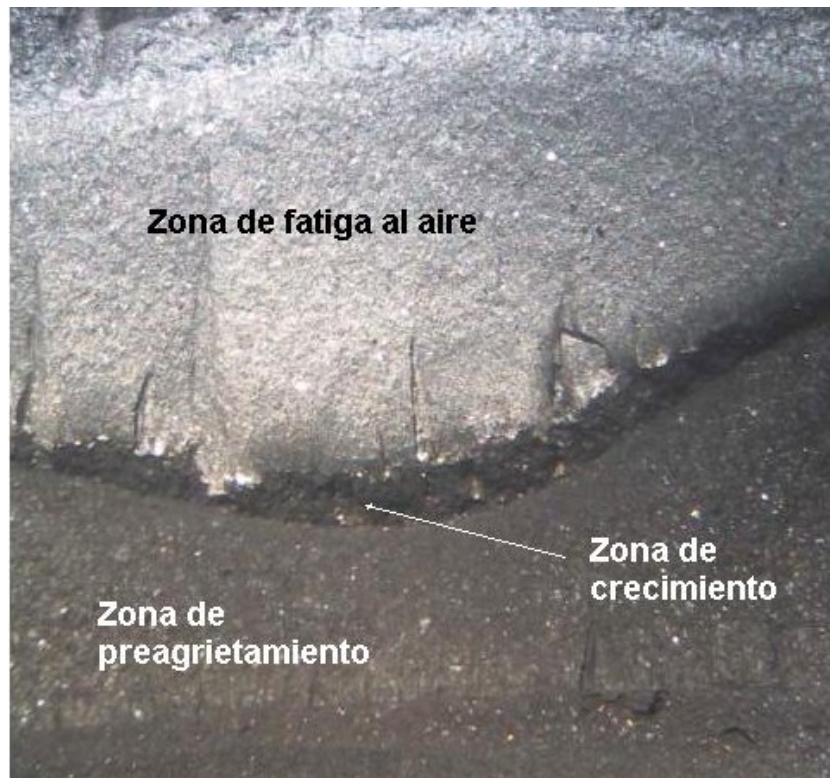
Figura 3.8 Fotografía que identifica la zona de preagrietamiento al aire por fatiga, la zona de crecimiento de grieta en autoclave y la zona de fatiga al aire para separar las superficies de fractura.
