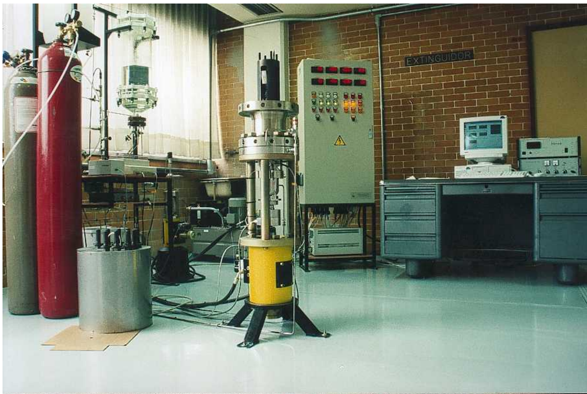
Figura 2.23 Fotografía que muestra la autoclave anexa al sistema de carga y al loop de recirculación y acondicionamiento, para realizar ensayos de inicio y propagación de grieta en condiciones similares a las de un BWR.
