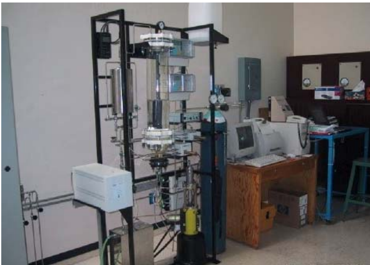
Figura 2.25 Acondicionamiento del agua fuera de la celda caliente en el sistema MEX-03.
