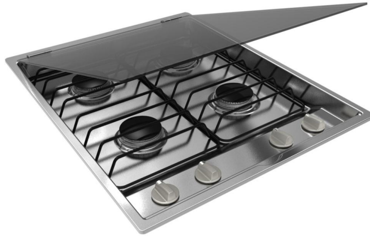
Figura 45. Vista de la propuesta de parrilla oculta con un capelo marca Mabe. La marca Mabe presenta cubierta de acero inoxidable con parrillas de alambroñ o solera. Las perillas son inyectadas con un inserto cromado. Elaboración propia.
