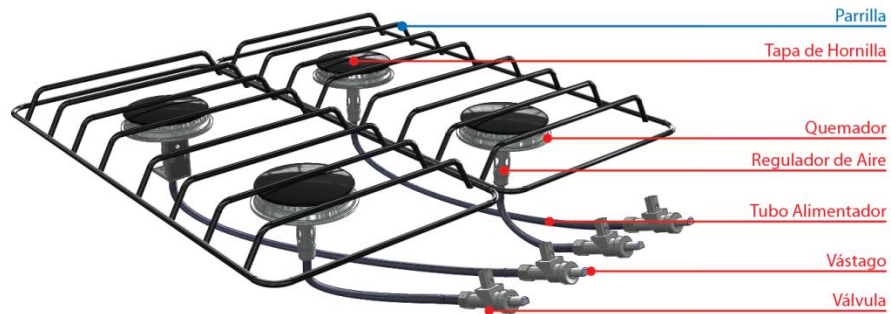
Figura 31. Partes utilizables de la plataforma Kyliá de la marca IEM. En rojo las partes que deben utilizarle y en azul las opcionales. Elaboración propia.
