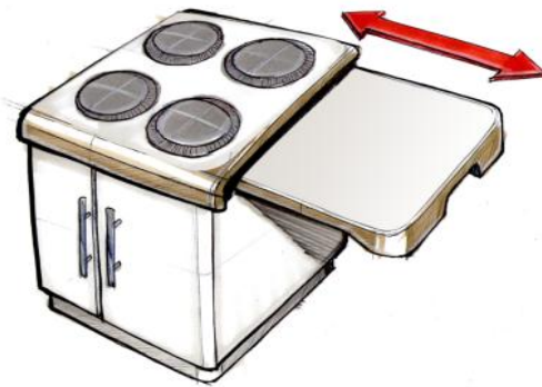
Figura 23. Boceto conceptual del sistema de corte y picado retráctil lateral El objeto no es aplicable a cocinas integrales, donde la cubierta va de lado a lado. Elaboración propia.
