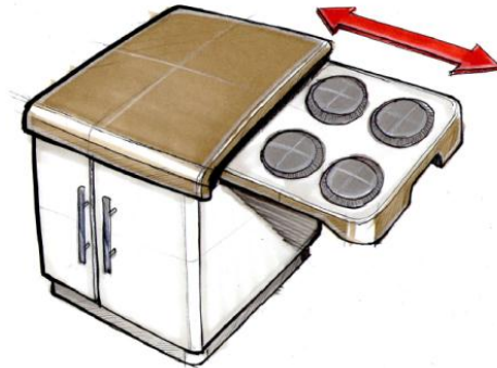
Figura 24. Ejemplo de un sistema de cocción retráctil. En el ejemplo el sentido del sistema es lateral hacia la derecha del usuario. Elaboración propia.
