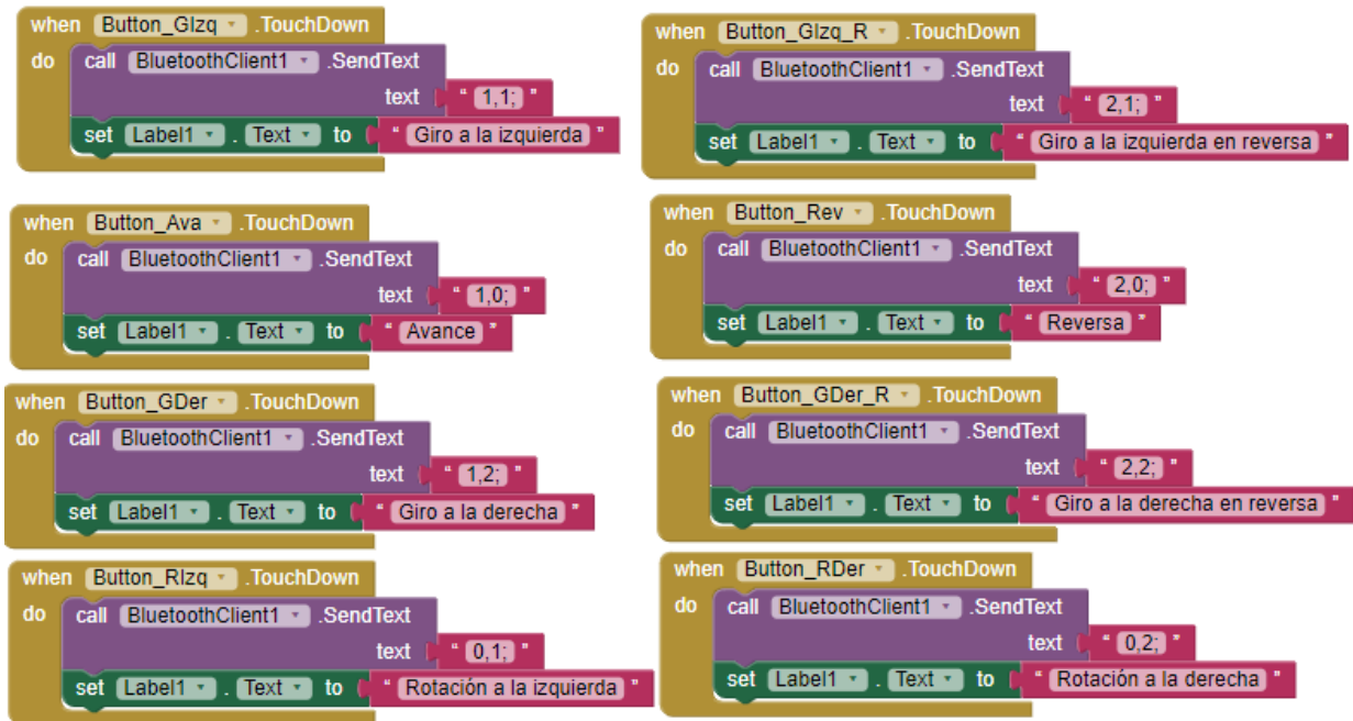
Figura 4.13 Bloques de programación para ejecutar los comandos
