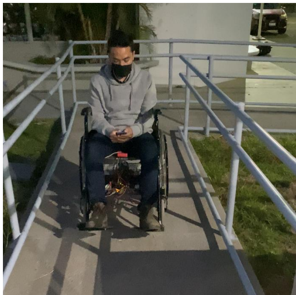
Figura 4.29 Ejemplo de prueba de recorrido de la silla de ruedas por una rampa con pendiente dentro de la norma
