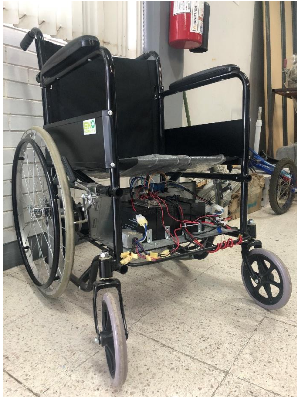
Figura 4.7 Fotografía de la silla de ruedas con todos los componentes integrados
