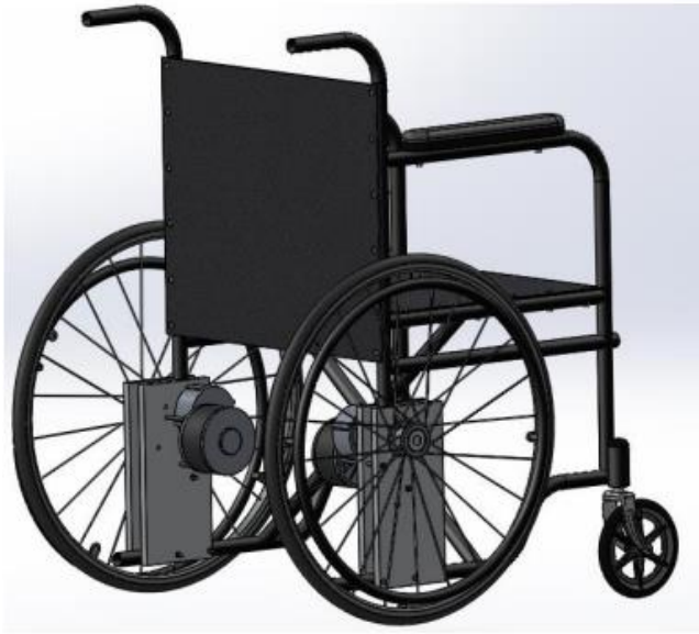
Figura 3.3 Vista de motores soportados por las bases que se acoplaran a la silla de ruedas (Izquierda). Vista de baterías soportadas por la base que se acoplará a la silla de ruedas (Derecha) (Castillo G. Sin publicar)
