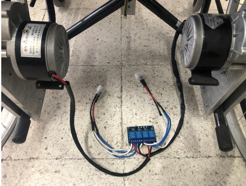
Figura 4.5. Fotografía de ejemplo que muestra la conexión eléctrica entre motores y módulo de relevadores
