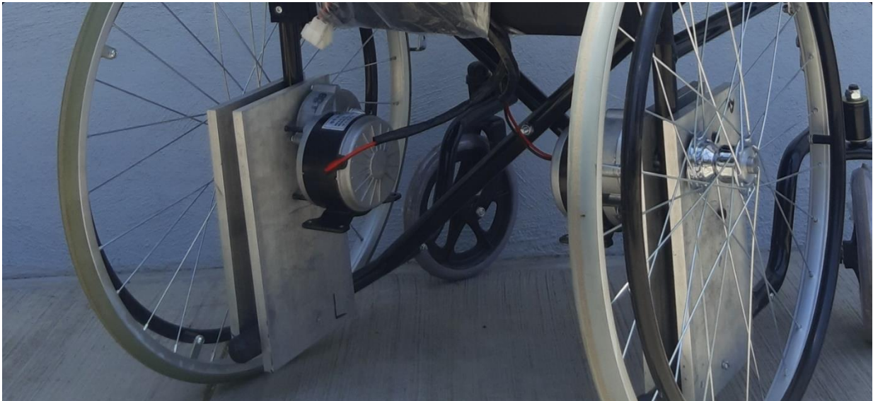
Figura 4.3 Ejemplo fotográfico de cómo se observa la adaptación de los motores a los rines de la silla de ruedas
