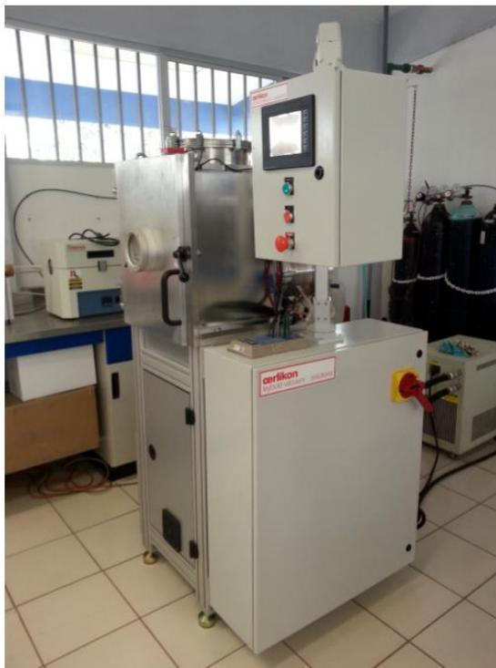
Figura 15. Sistema de crecimiento de películas en el laboratorio de materiales avanzados UAQ (Oerlikon Leybold Vacuum Solutions).
