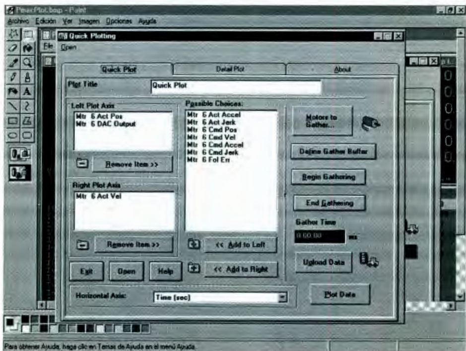
Figura 4.42 Utilería “Quick Plot” para monitoreo de las variables del servosistema
