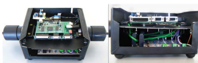
Figura 3.8: Sistema de monitoreo eléctrico basado en FPGA.
