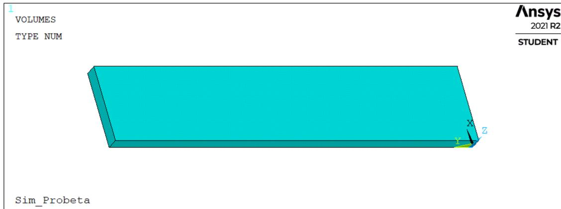
Figura 3.5: Creación de la probeta con el comando "Block"- Cortesía de ANSYS
