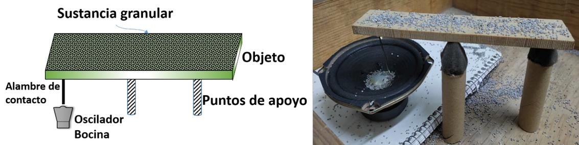
Figura 3.4: Diagrama esquemático(Izquierda) y montaje real (derecha) para sostener la probeta para el experimento de Chladni
