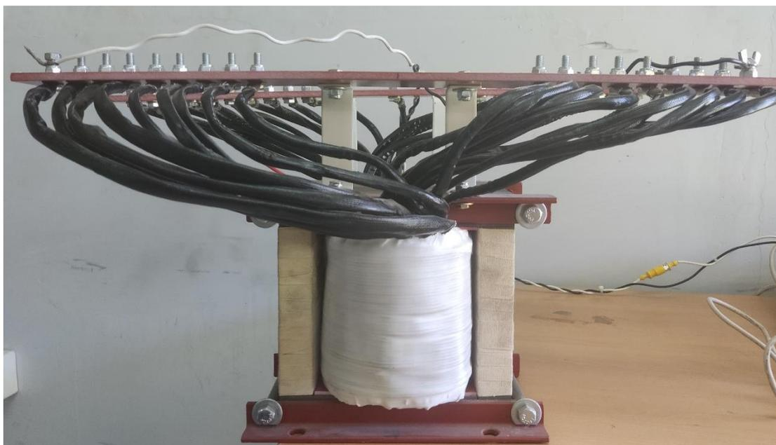
*Figura 23.- Transformador a utilizar.*
