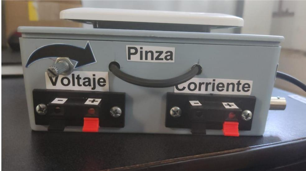
*Figura 25.- Salidas del sistema de monitorio de voltaje y corriente.*
