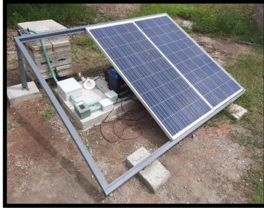
Figura 29 Instalación física del banco de pruebas para sistema fotovoltaicos, (autoría propia)
