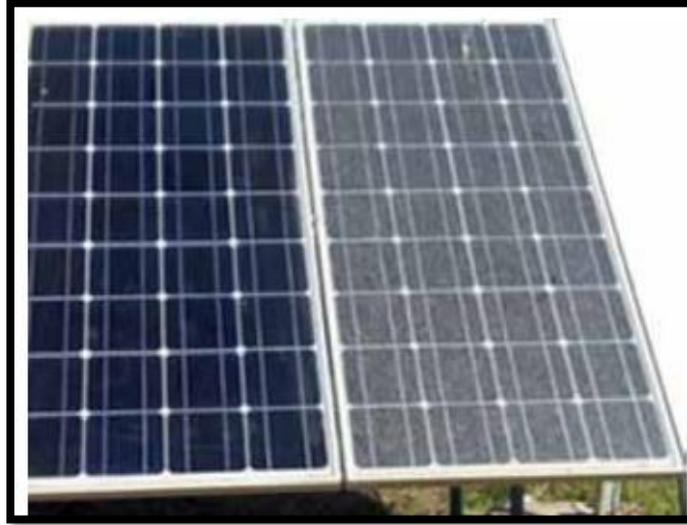
Figura 1 Panel limpio y panel con acumulación de polvo, Memiche et al. (2020).
