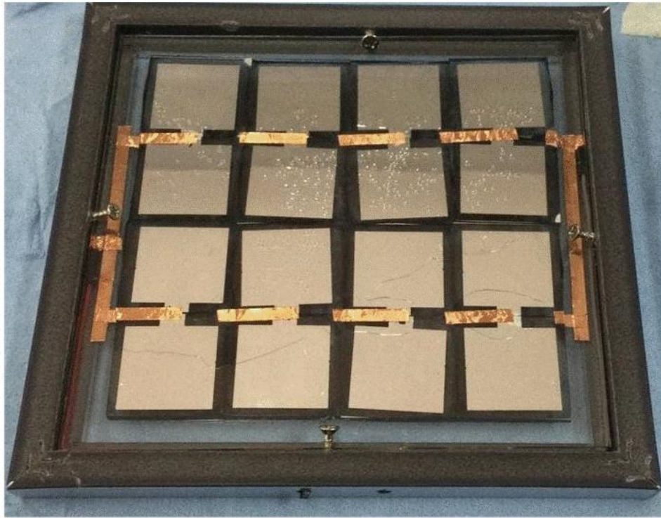
Figura 19. Imagen del panel solar terminado (lado de las conexiones).
