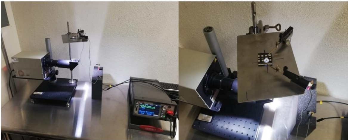
Figura 49. Imagen de las conexiones para medir las celdas solares utilizando el simulador solar y la fuente marca Keithley modelo 2450.
