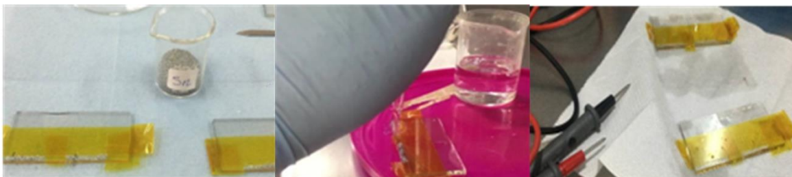
Figura 29. Diseño sobre el FTO utilizando estaño y ácido clorhídrico.
