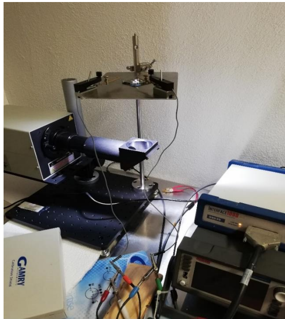
Figura 51. Conexiones para la medición de impedancia de una celda solar con equipo GAMRY 1000.
