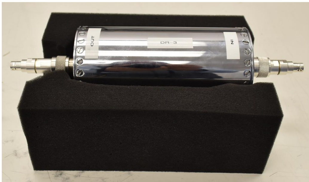
Figura 4-18. Divisor de tensión resistivo modelo 2020 desarrollado en el CENAM en el marco de la investigación de métodos de medición de referencia para metrología de calidad de la potencia (autoría propia).
