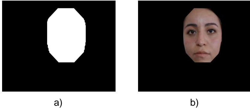
Figura 3.10. Resultado de la apertura viscosa, a) Máscara obtenida, b) Rostro con colores de la imagen original.
