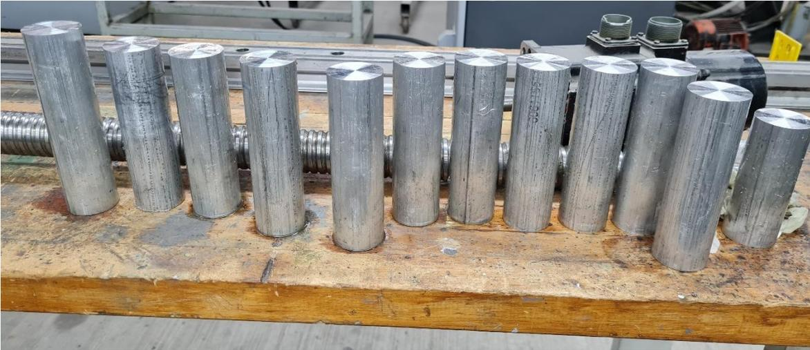
*Figura 3.5. Barras de aluminio 6061 preparadas para las pruebas.*
