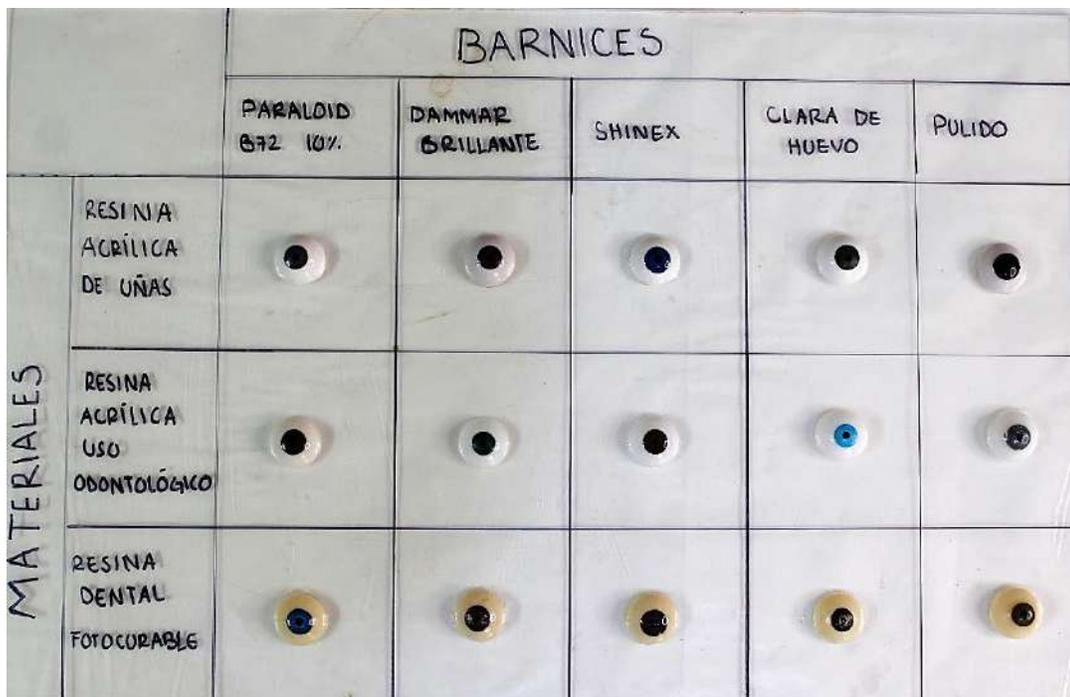
Figura 15. Placa de acrílico con probetas.
