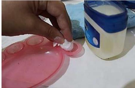
*Figura 9.* Lubricado de Molde.
