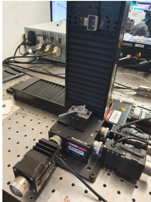
Figura 3.13: Arreglo del Interferómetro Fabry-Pérot donde la fibra óptica se encuentra sobre el cantilever inmerso en una solución (autoría propia).
