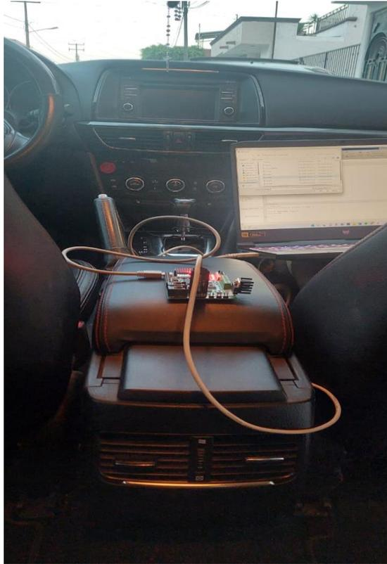
Figura 14. Tarjeta FPGA conectada a PC vista desde la parte trasera del automóvil
