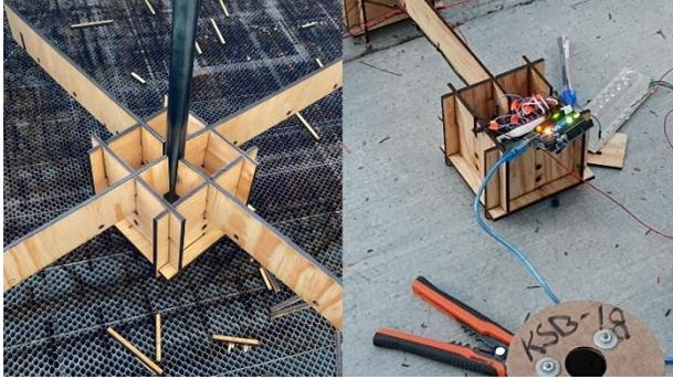
**Figura 103:** Las piezas de madera cortadas en laser disponían de la ventaja de ser ensamblables entre sí, permitiendo así un flujo de trabajo más rápido para el proyecto. Fuente: Diplomado en diseño y composición paramétrica (2021)
