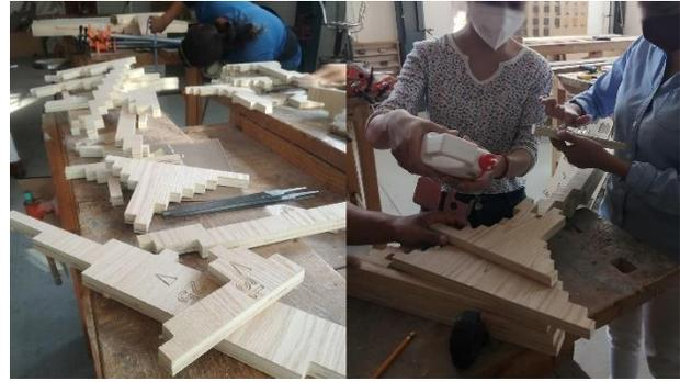
**Figura 98:** Una vez separadas e identificadas las piezas, se lijaron, pegaron y prensaron en módulos para posteriormente conformar bloques mayores del mueble. Fuente: Diplomado en diseño y composición paramétrica (2021)
