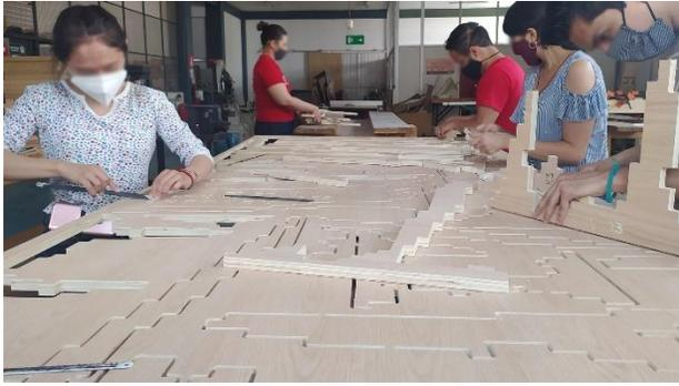
**Figura 97:** Las piezas cortadas en router CNC además requirieron posteriormente ser separadas por medio de cortes adicionales de las placas de madera, y cuidadosamente agrupadas para no generar confusión en su posterior ensamble. Fuente: Diplomado en diseño y composición paramétrica (2021)
