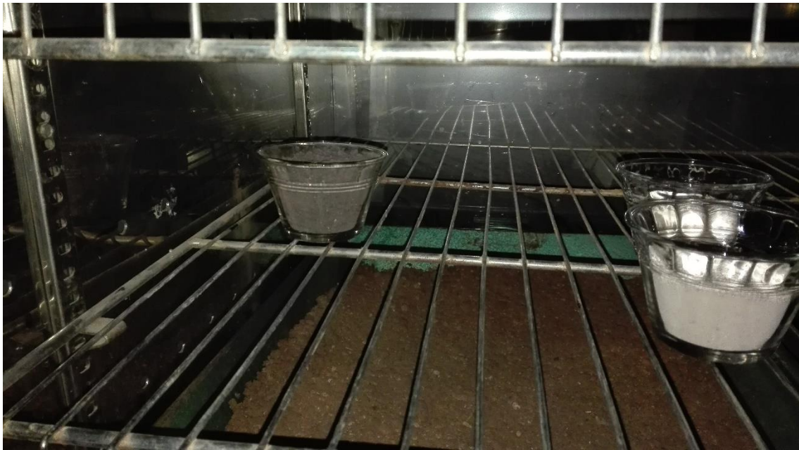
9-33 Flanera con suelo expansivo en horno como testigo de humedad de la prueba densidad in situ.
