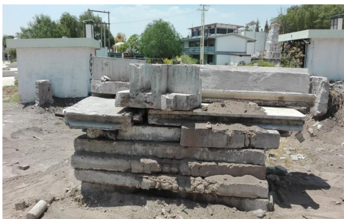
4-12 Carga estructural de 3.24 ton/m 2 colocada en sitio.
