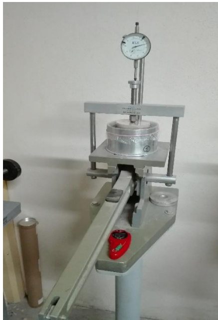
9-39 Anillo montado en el consolidómetro durante prueba de expansión-consolidación.
