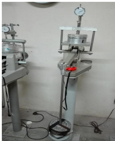
5-9 Muestra montada en el consolidómetro.
