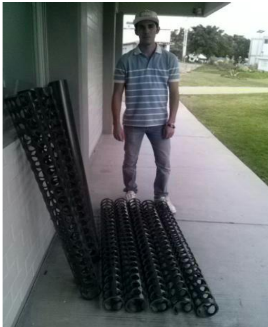
9-21 Tubos de Policloruro de vinilo( PVC) C80 totalmente perforados con diámetros de 5 cm.
