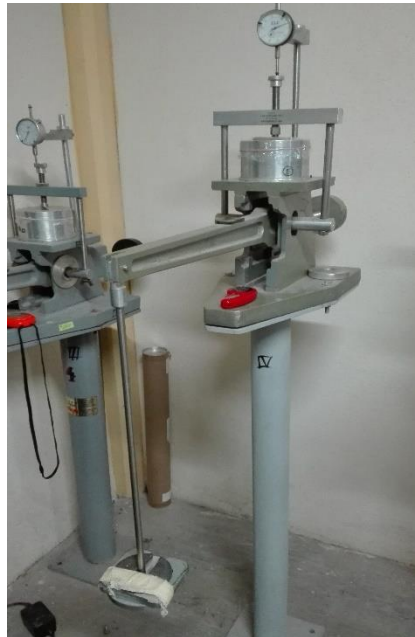
9-40 Prueba de expansión-consolidación en proceso.
