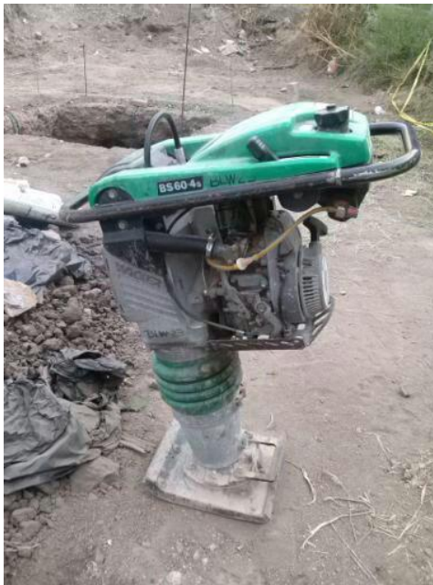
9-25 Maquinaria ligera vibro compactador Marca Wacker.
