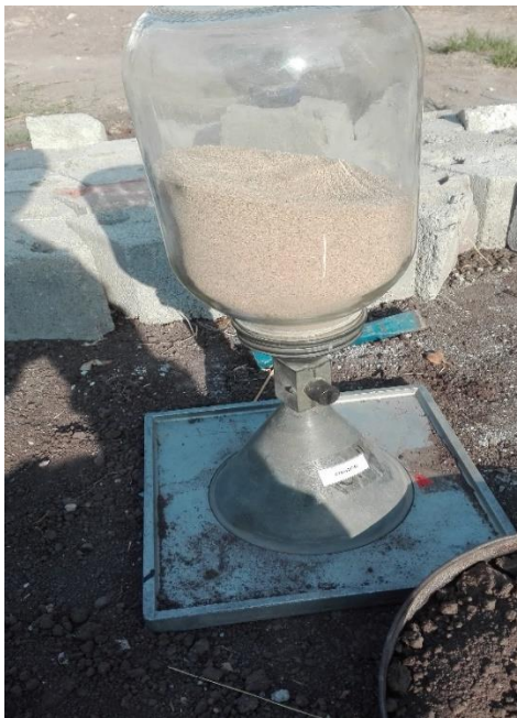
5-3 Arena fluyendo del frasco hacia el agujero excavado.
