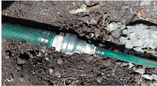
4-13 Conexión de mangueras mediante una reducción tipo espiga.
