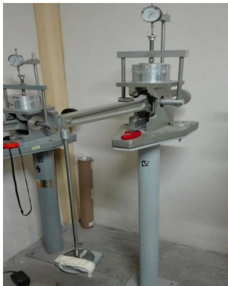
4-16 Anillo montado en equipo consolidómetro para la prueba de expansión-consolidación.
