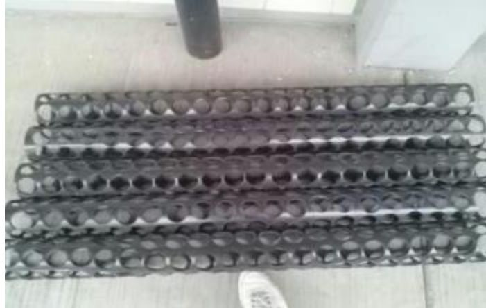
4-7 Tubos PVC C80 con diámetro de 10 cm.
