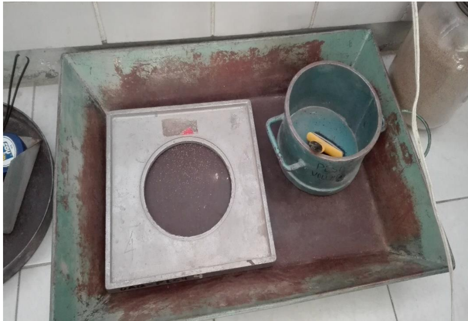
9-28 Herramienta para realizar la prueba de densidad in situ.
