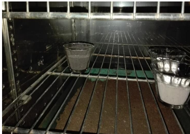
5-5 Del lado izquierdo se aprecia una muestra en el horno del suelo expansivo para determinar el contenido de humedad.
