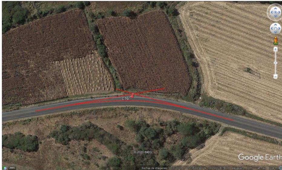
Figura 6.4. Trazo de polilínea en el centro de la curva y de dos líneas tangentes.
