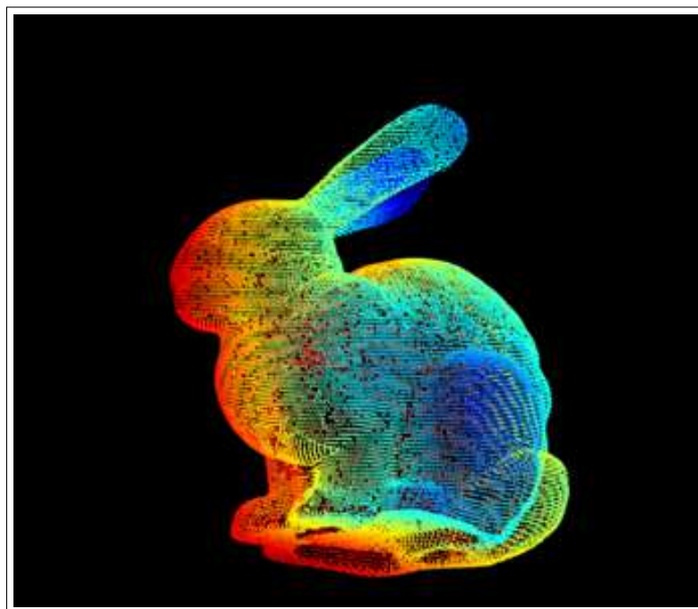
Figura 2.2: Reconstrucción del conejo de Stanford realizada con un scanner Cyberware 3030 MS, nube de puntos 3D tomados de (Curless and Levoy, 1996).
