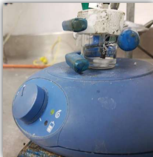
Figura 5.1 Acomodo de electrodos usado para la realización de pruebas electroquímicas.
