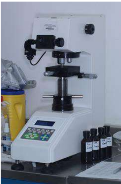
Fig. 7 fotografía de la máquina probadora de microdurezas Vickers modelo HV-5 marca CMS METROLOGY
