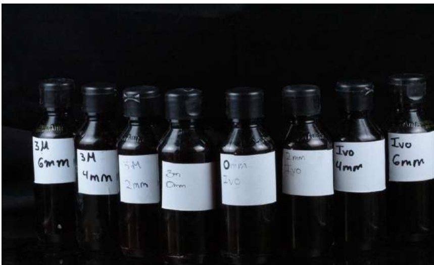
Fig. 6 fotografía donde se muestra el almacenamiento de las muestras en frascos de vidrio color ámbar con agua destilada a 37 grados centígrados.
