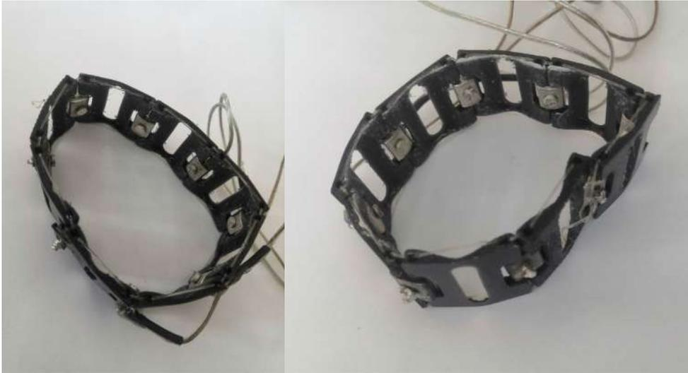
Figura 3.8. El brazalete, conformado por los eslabones hechos en 3D, los electrodos de plata unidos con hilo elástico.
