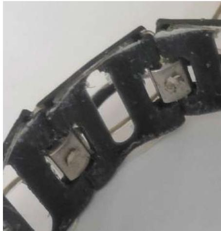
*Figura 2.3.* Electrodo de plata soldados a estructura de acero inoxidable, con la finalidad de estabilidad en el brazalete.
