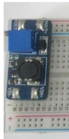
*Figura 3.10.* Convertidor de 3.3V a  $\pm 12V$ . *Figura 3.11.* Módulo regulador de voltaje.
