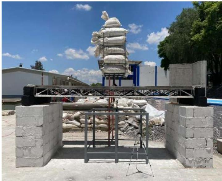
**Figura 5.1** Modelo de experimental con la carga P aplicada en el ensaye resistencia a flexión bajo una carga puntual, (fuente propia 2021).
