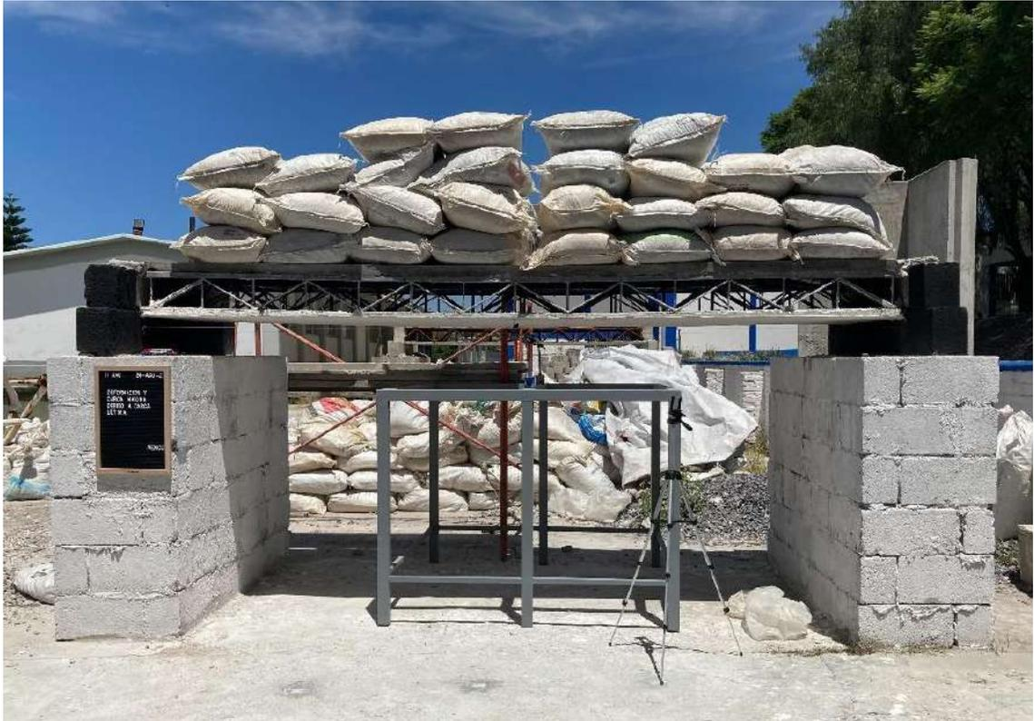
**Figura 5.9** Modelo experimental con la carga uniformemente distribuida  $W$  aplicada en el ensaye carga última, (fuente propia 2021).
