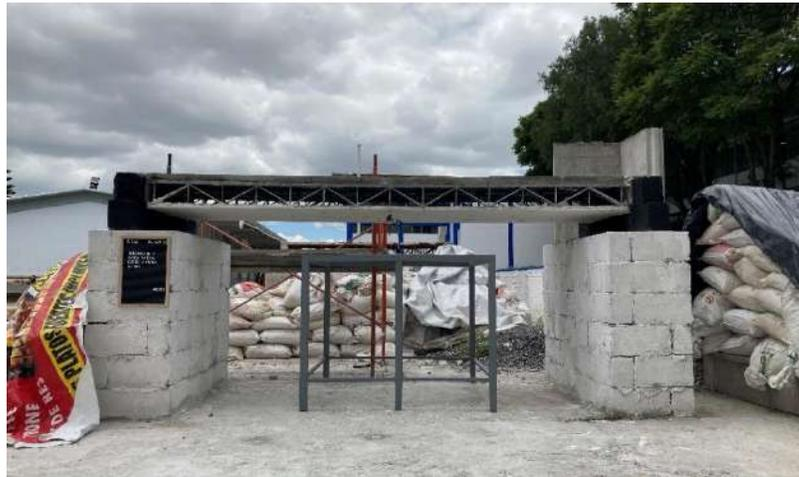
**Figura 4.29** Modelo experimental descargado en el ensaye carga última, (fuente propia 2021).
