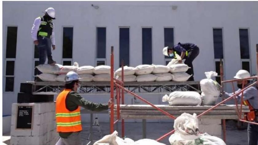
**Figura 4.27** Aplicación de la carga monótona creciente distribuida en el ensaye carga última, (fuente propia 2021).
