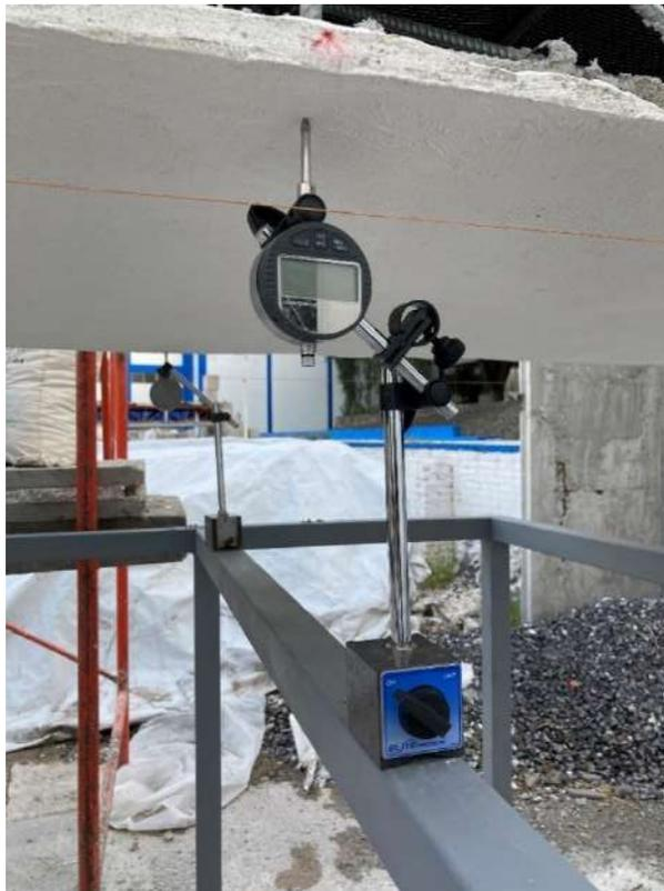
**Figura 4.21** Colocación de los micrómetros en el ensaye carga de servicio mínima, (fuente propia 2021).
