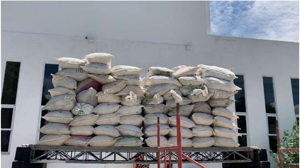
**Figura 4.31** Aplicación de la carga uniformemente distribuida total de la primera etapa de carga, en el ensaye al colapso, (fuente propia 2021).
