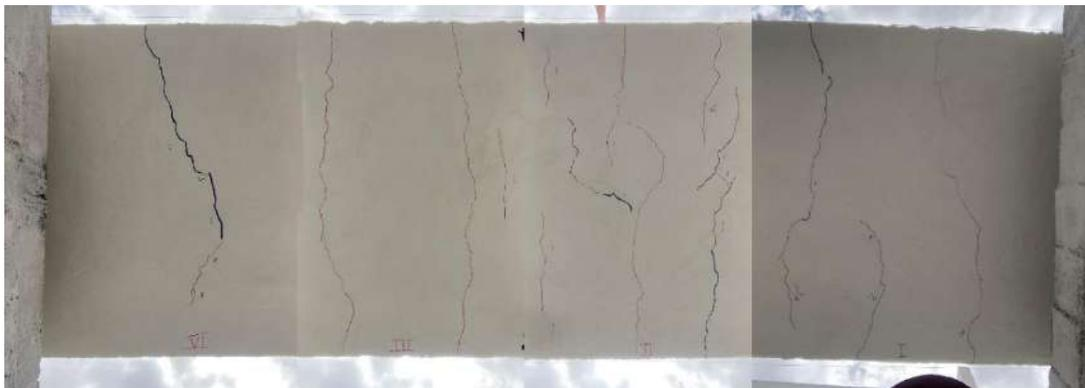
**Figura 5.12** Cara inferior de sistema LTM de ensaye, con grietas en acabado, sin daño estructural, en el ensaye carga última (fuente propia 2021).
