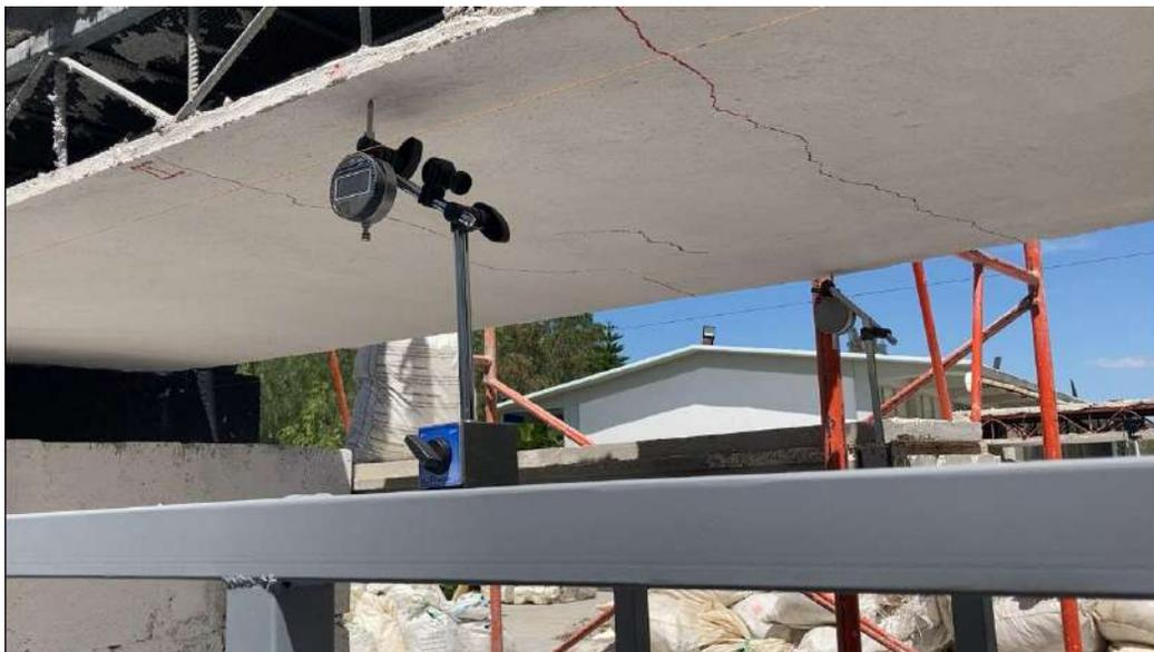
**Figura 4.26** Colocación de los micrómetros en el ensaye carga última, (fuente propia 2021).
