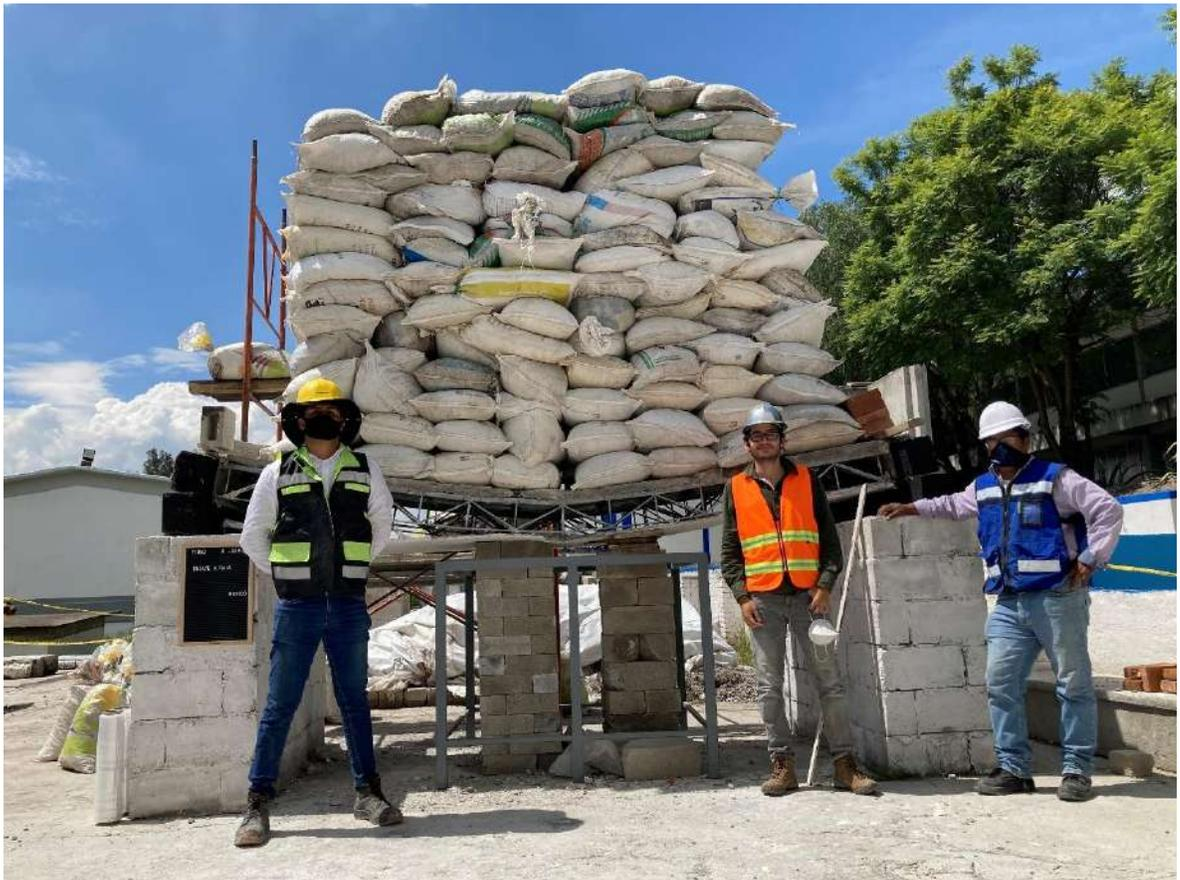
**Figura 4.34** Aplicación de la carga uniformemente distribuida total en la cuarta etapa de carga, en el ensaye al colapso, (fuente propia 2021).
