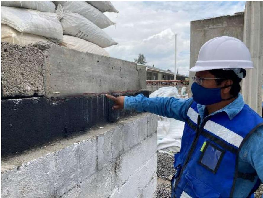
**Figura 5.20** Grietas debidas a la rotación en apoyos que se presentan en la tercera etapa de carga del ensaye al colapso, (fuente propia 2021).
