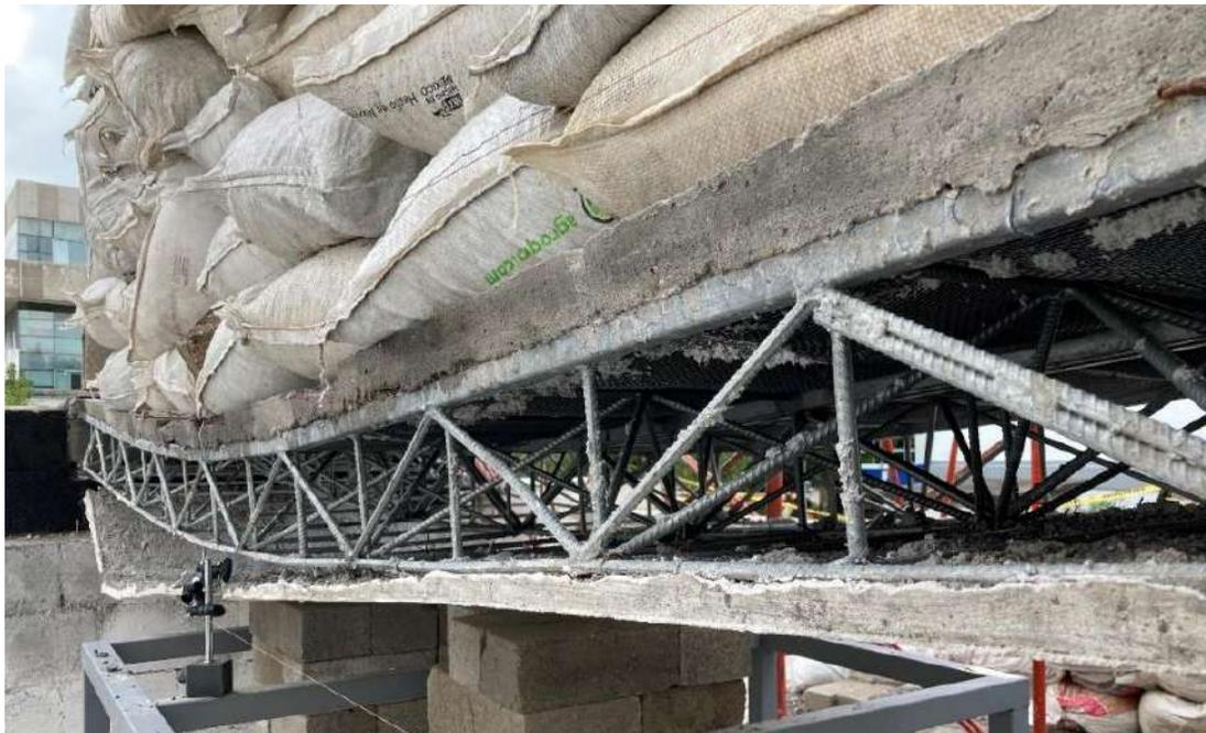
**Figura 5.19** Vista lateral del modelo experimental en la tercera etapa de carga del ensaye hasta el colapso, (fuente propia 2021).
