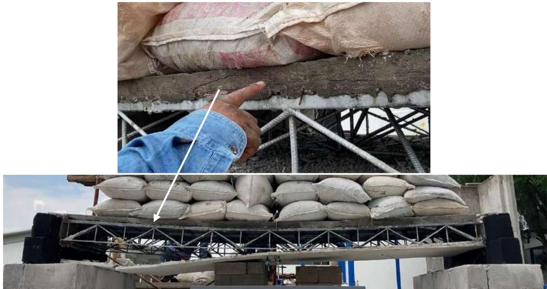
**Figura 5.21** Grietas en la capa de compresión en la tercera etapa de carga del ensaye al colapso, (fuente propia 2021).
