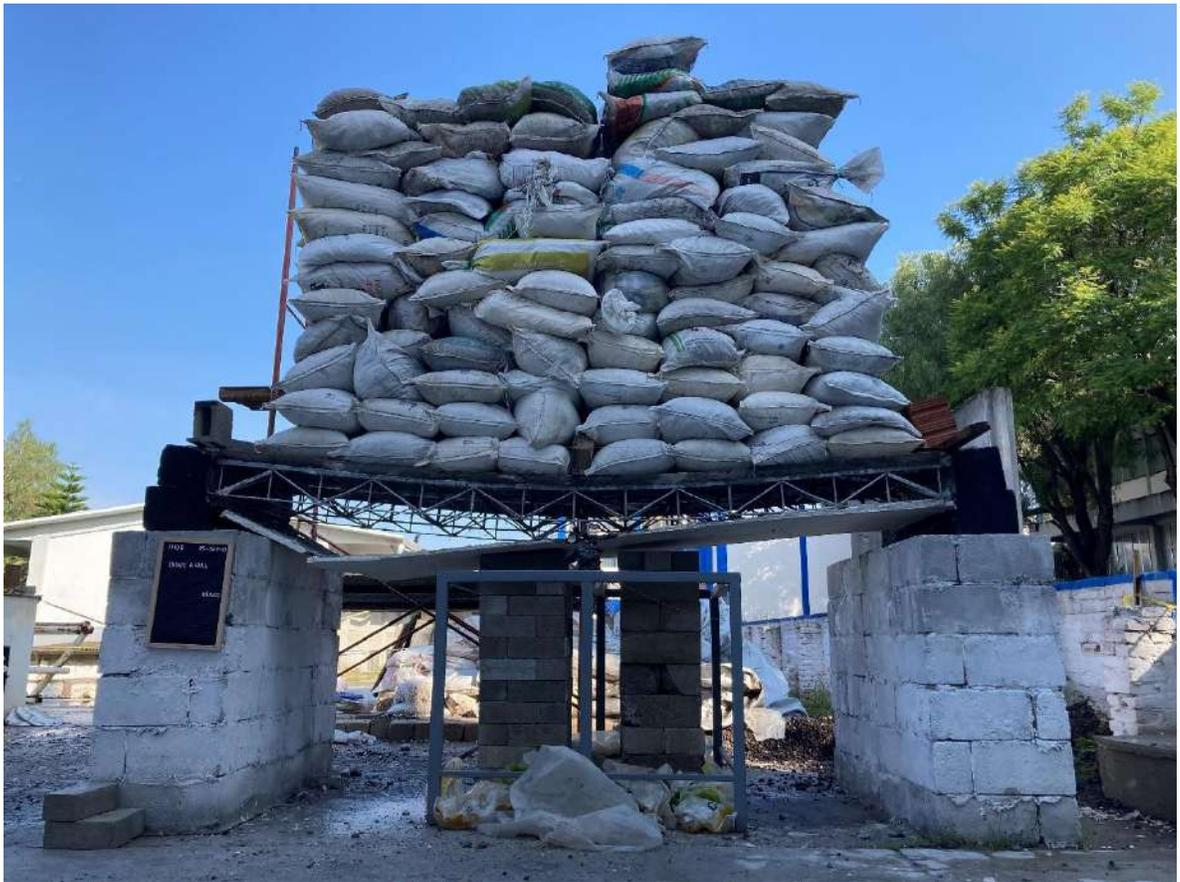
**Figura 4.33** Aplicación de la carga uniformemente distribuida total de la tercera etapa de carga, en el ensayo al colapso, (fuente propia 2021).
