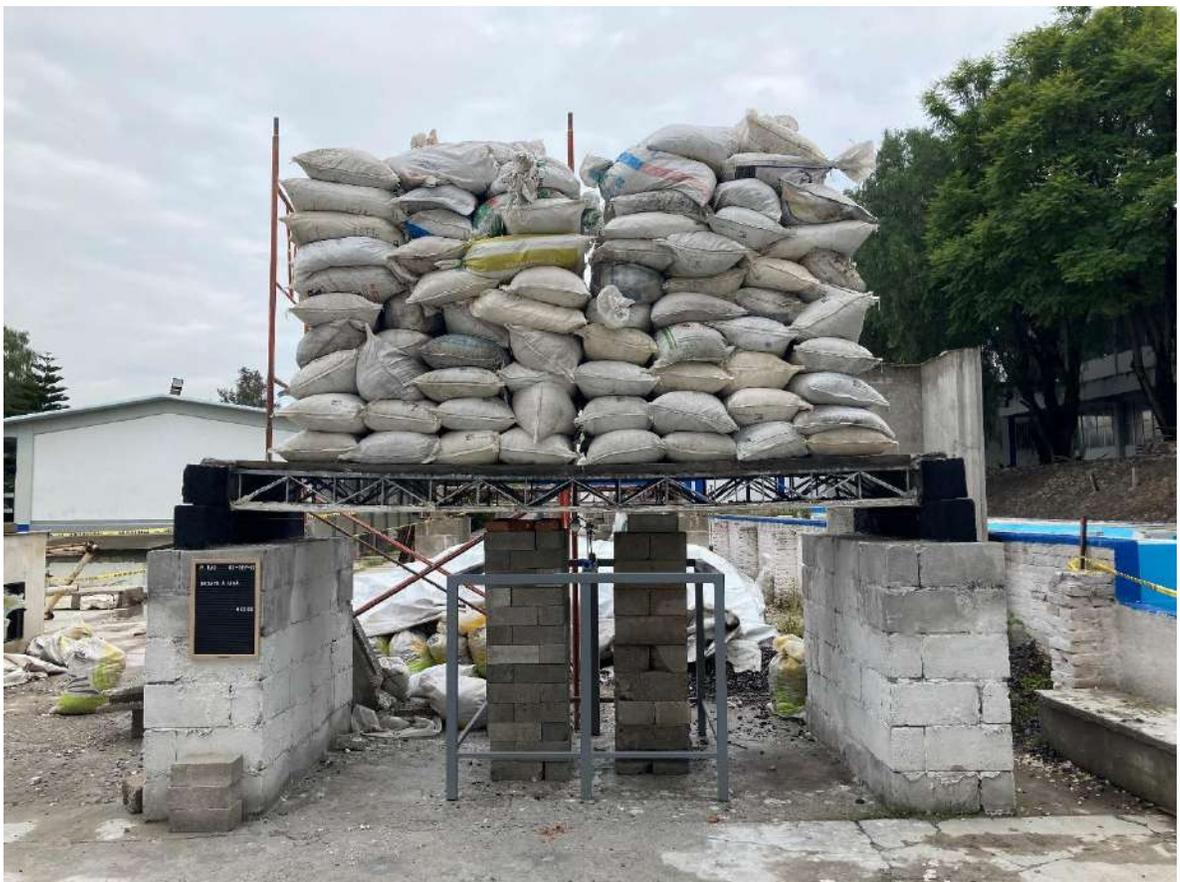
**Figura 4.32** Aplicación de la carga uniformemente distribuida total de la segunda etapa de carga, en el ensaye al colapso, (fuente propia 2021).
