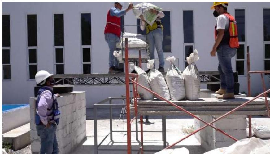
**Figura 4.18** Aplicación de la carga monótona creciente vertical para el ensaye resistencia a flexión bajo una carga puntual, (fuente propia 2021).
