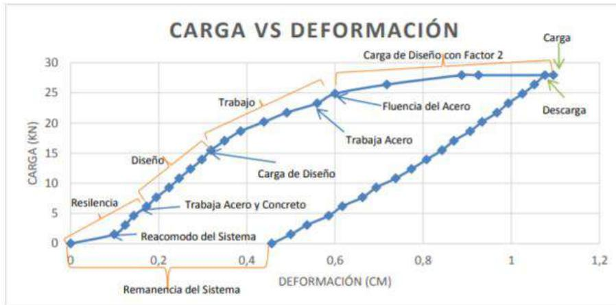
**Figura 2.14** Curva carga vs deformación del sistema vigueta y bovedilla, (Hernandez Chamalé, 2017)
