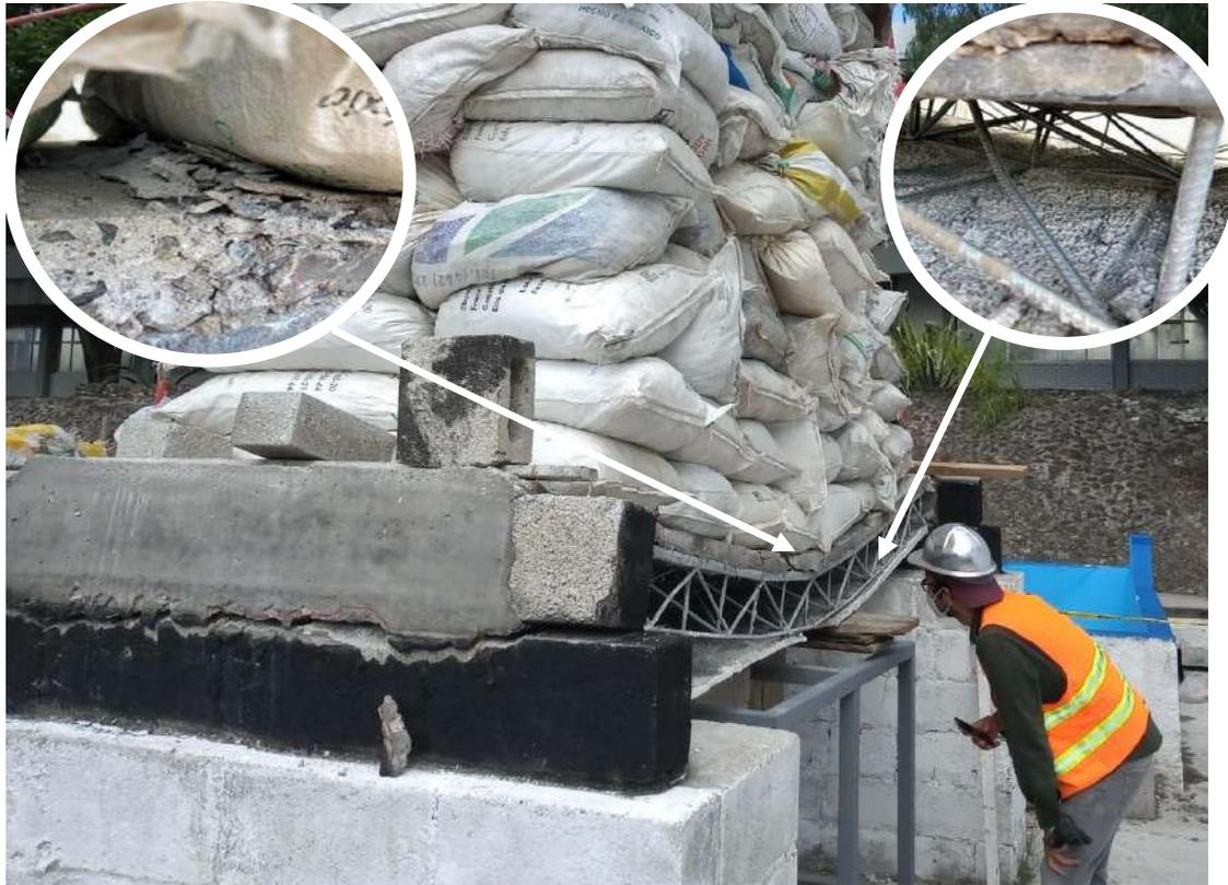
**Figura 5.24** Colapso del modelo experimental en la cuarta etapa de carga del ensaye al colapso, (fuente propia 2021).
