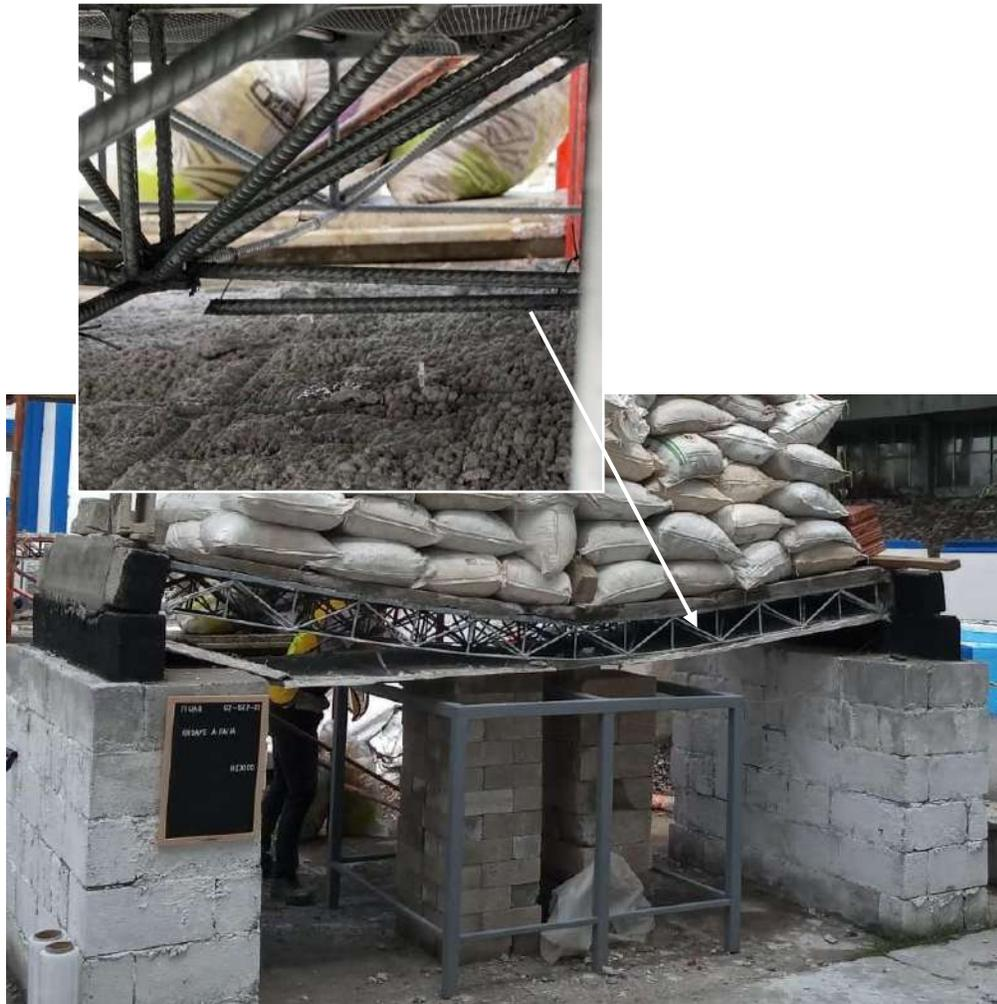
**Figura 5.23** Elemento con falla al centro del sistema LTM de la cuarta etapa de carga del ensayo al colapso, (fuente propia 2021).
