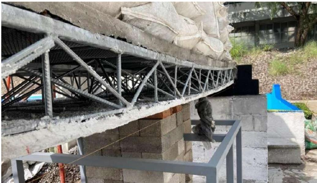
**Figura 5.18** Vista lateral del modelo experimental en la segunda etapa de carga del ensaye al colapso, (fuente propia 2021).
