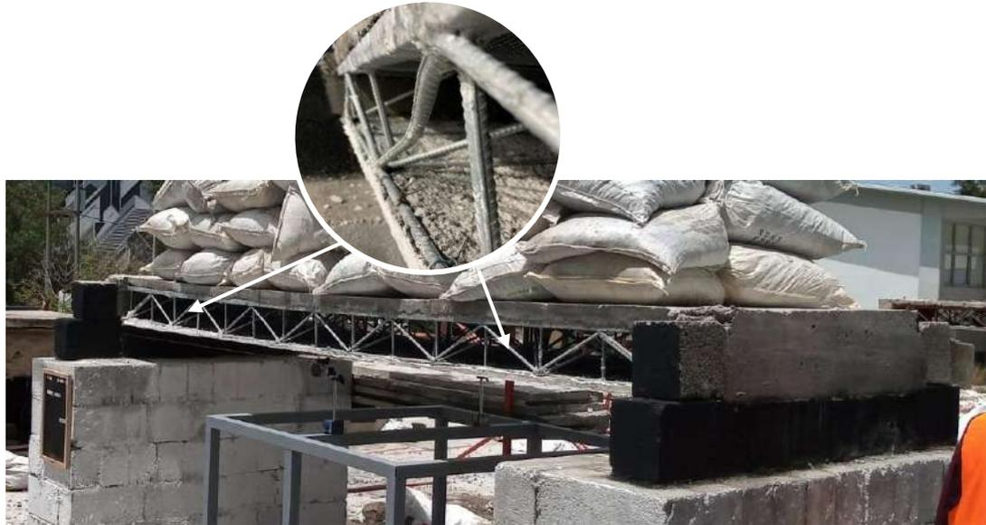
**Figura 5.14** Primer elemento que falla a compresión en la primera etapa de carga del ensayo al colapso, (fuente propia 2021).
