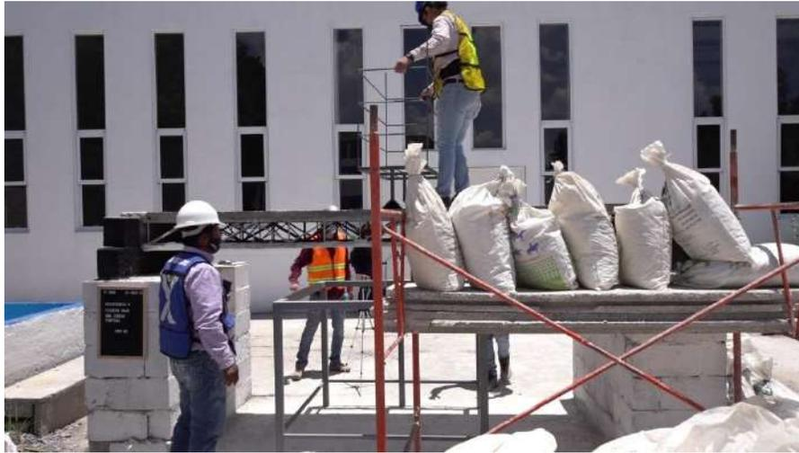
**Figura 4.17** Colocación de la canastilla de presión en el modelo experimental; para el ensaye resistencia a flexión bajo una carga puntual, (fuente propia 2021).
