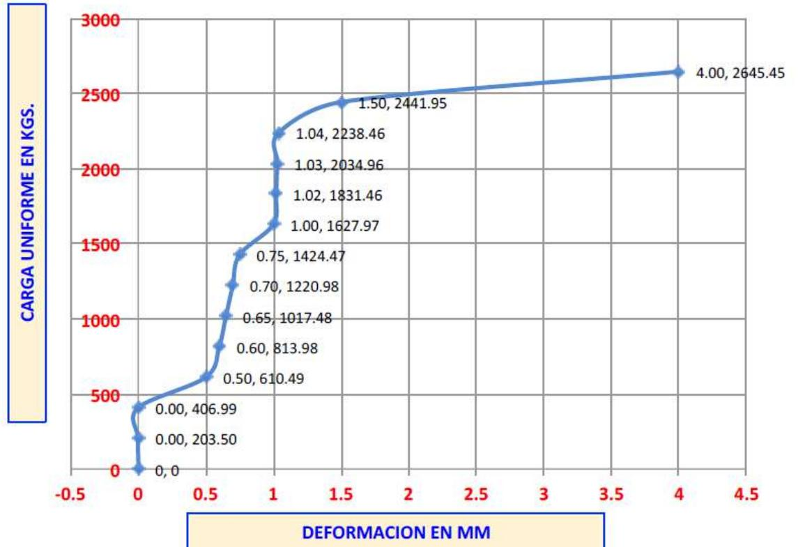
**Figura 2.8** Gráfica curva esfuerzo deformación del elemento losacero, (Coordinadora SFS México SA de CV, 2018).
