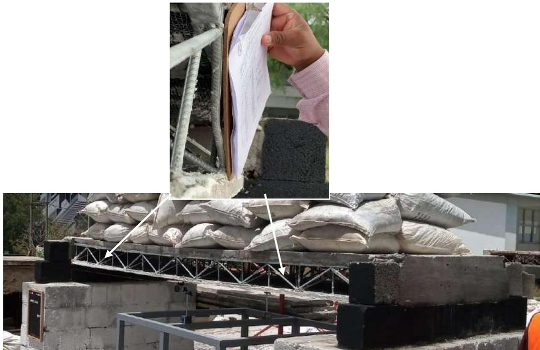
**Figura 5.17** Elementos con falla a compresión en la segunda etapa de carga del ensaye al colapso, (fuente propia 2021).
