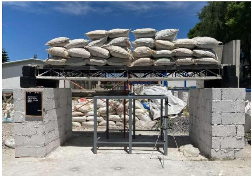
**Figura 4.28** Modelo de experimental con la carga uniformemente distribuida  $W$  aplicada en el ensaye carga última, (fuente propia 2021).
