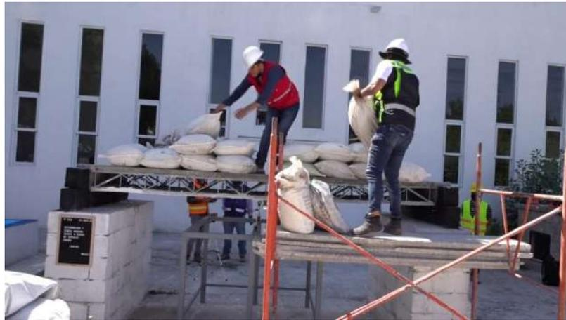
**Figura 4.22** Aplicación de la carga monótona creciente distribuida en el ensaye carga de servicio mínima, (fuente propia 2021).
