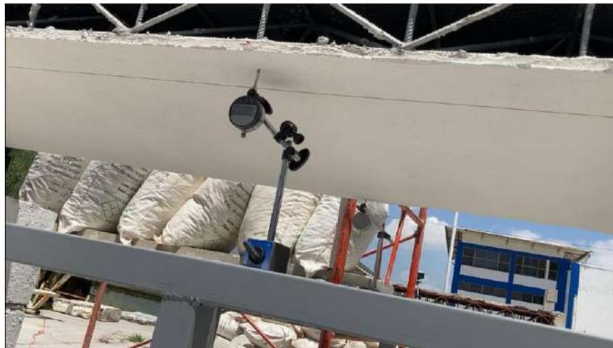
**Figura 4.16** Colocación de los micrómetros para el ensaye resistencia a flexión bajo una carga puntual, (fuente propia 2021).
