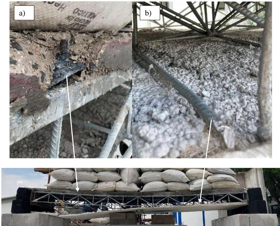
**Figura 5.22** a) Pernos de sujeción visibles, b) quinto elemento en fallar del sistema LTM en la tercera etapa de carga del ensaye al colapso, (fuente propia 2021).
