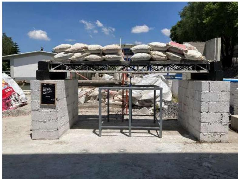
**Figura 4.23** Modelo experimental con la carga uniformemente distribuida  $W_s$  aplicada en el ensaye carga de servicio mínima, (fuente propia 2021).
