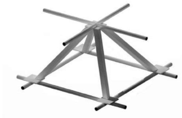
**Figura 2.20** Figura piramidal de la cual se compone la tridilosa, (Castillo Juárez, 2016).
