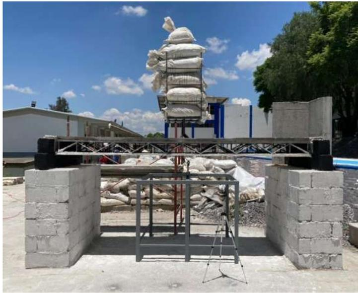
**Figura 4.19** Modelo experimental con la carga P aplicada para el ensaye resistencia a flexión bajo una carga puntual, (fuente propia 2021).
