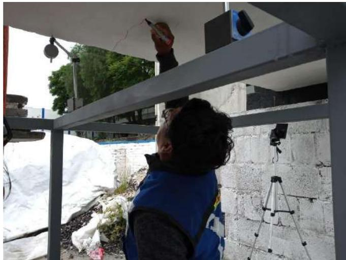
**Figura 4.25** Inspección visual cara inferior del sistema LTM en el ensaye carga de servicio mínima, (fuente propia 2021).
