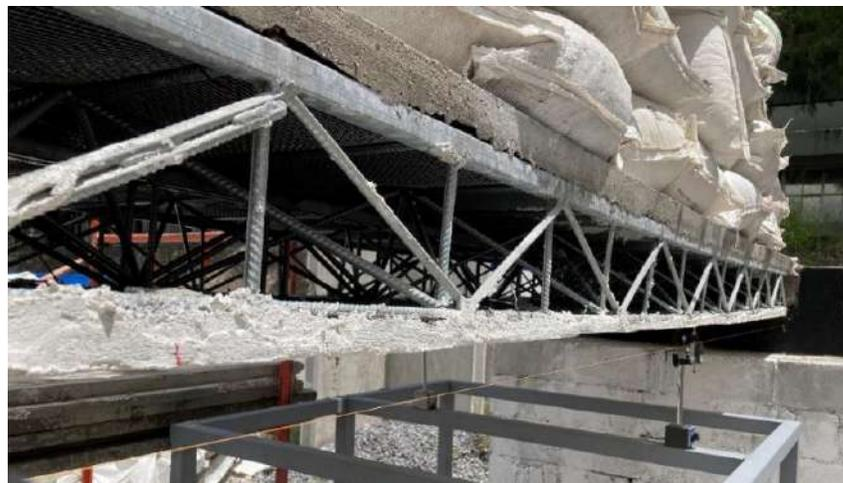
**Figura 5.15** Vista lateral del modelo experimental al terminar la primera etapa de carga del ensayo al colapso, (fuente propia 2021).
