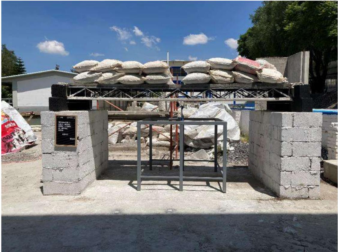
**Figura 5.5** Modelo de experimental con la carga uniformemente distribuida  $W_s$  aplicada en el ensaye carga de servicio mínima, (fuente propia 2021).
