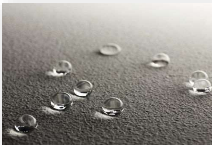
Fig. 2 Superficie hidrofóbica con baja energía superficial.
