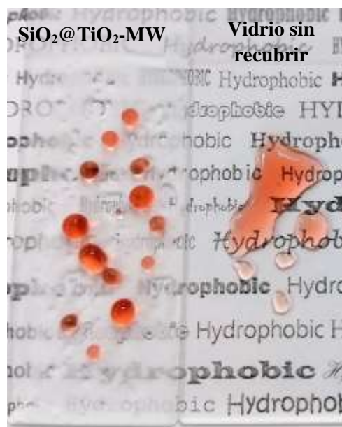
Fig. 14. Evaluación hidrofóbica del recubrimiento \text{SiO}_2@\text{TiO}_2\text{-MW} sin irradiación UV.
