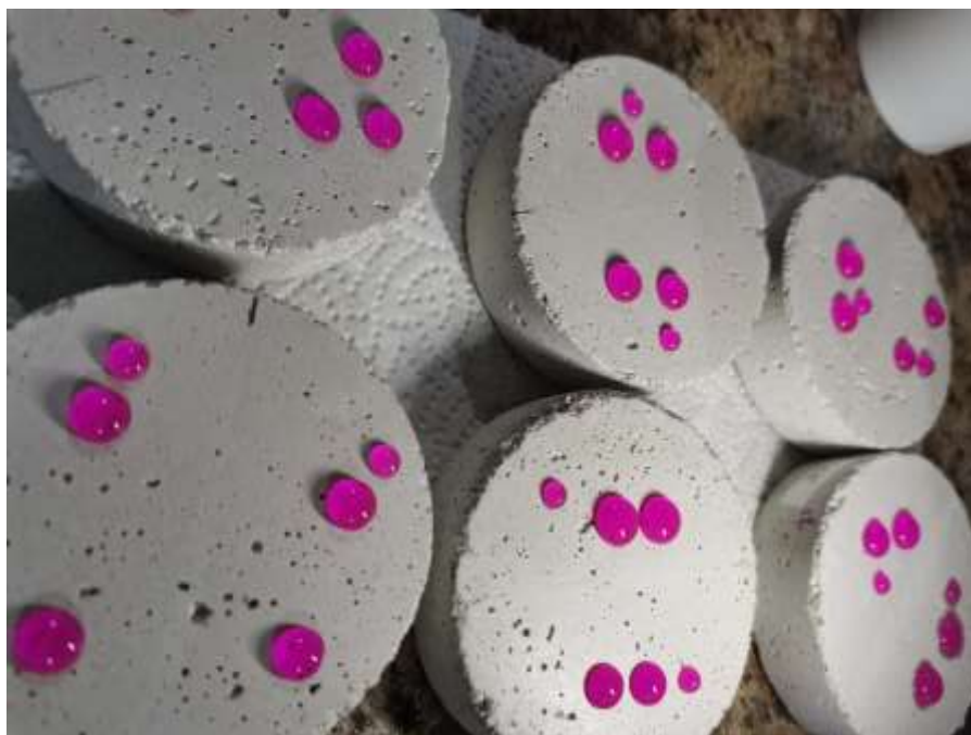
Fig. 28 Mortero recubierto con el composito \text{SiO}_2@\text{TiO}_2
