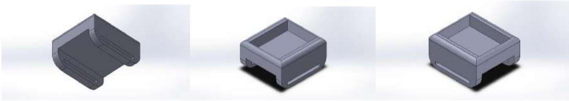
Figura 5.5 Porta-sensores en Solidworks
