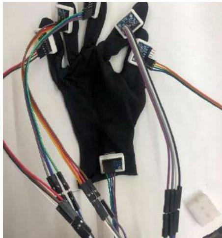
Figura 5.7 Prototipo con los porta sensores en cada dedo.
