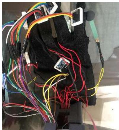
Figura 5.9 Sensores MPU-6050 en el guante
