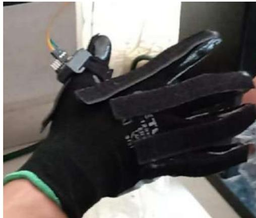
Figura 5.3 Prototipo con cintas velcros adheridas al guante
