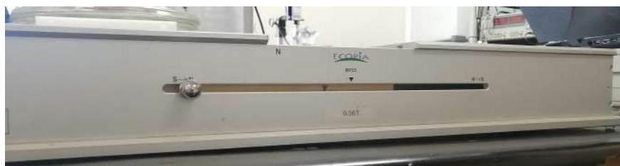
Figura 8.9. Sistema de medición de efecto Hall MP55T.
