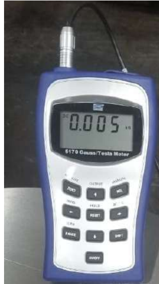
Figura 7.4. Gaussmetro marca FW Bell modelo 5170.
