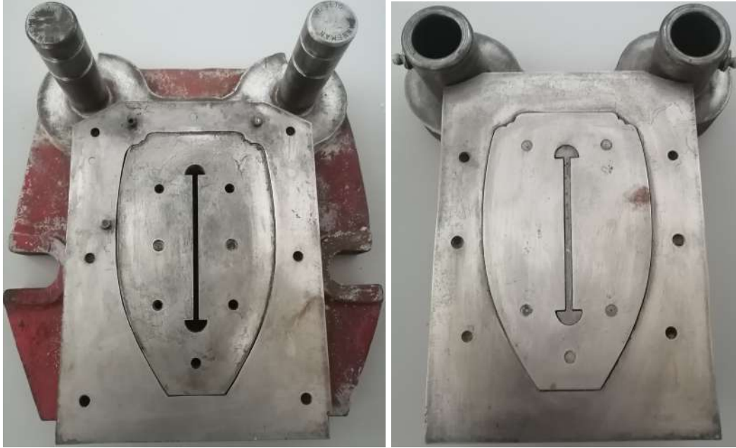
Figura 7.11. Parte superior e inferior del troquel.
