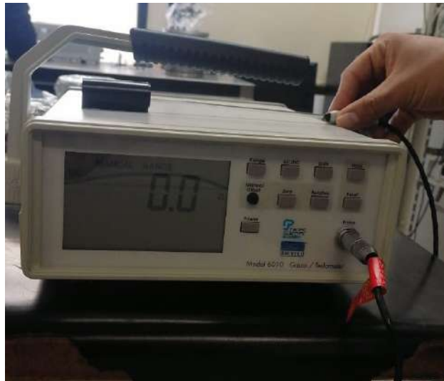
Figura 8.11. Calibración del cero relativo del gaussímetro.
