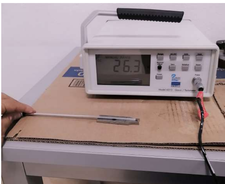
Figura 8.15. Lectura de campo magnético de la probeta.
