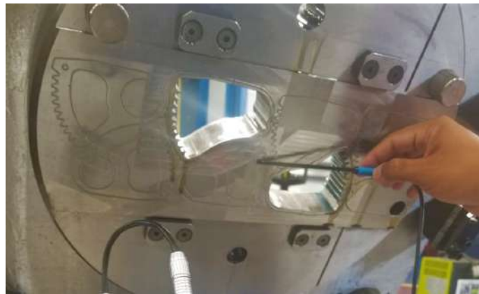
Figura 7.5. Toma de lecturas de campo magnético en troquel de fineblanking .
