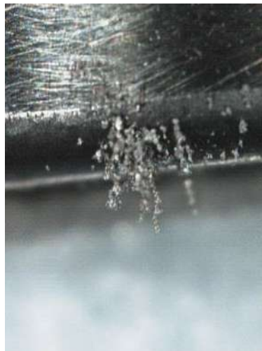
Figura 3.1. Atracción de partículas en un material ferromagnético [26].
