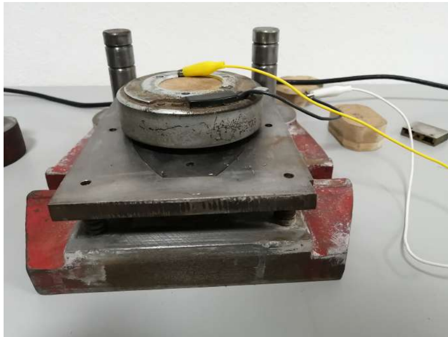
Figura 8.22. Bobina desmagnetizadora con suplemento implementado.
