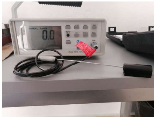
Figura 8.7. Gaussímetro FW Bell modelo 6010
