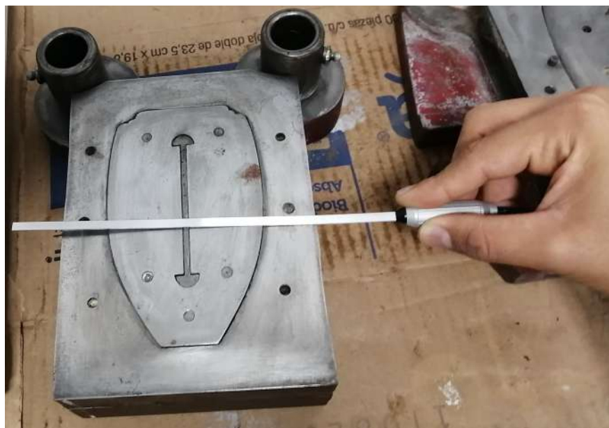
Figura 8.23. Medición de campo magnético en parte inferior.
