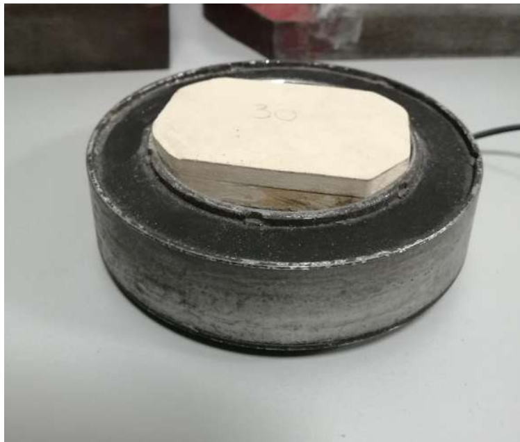
Figura 7.17. Bobina de arranque con carcasa.
