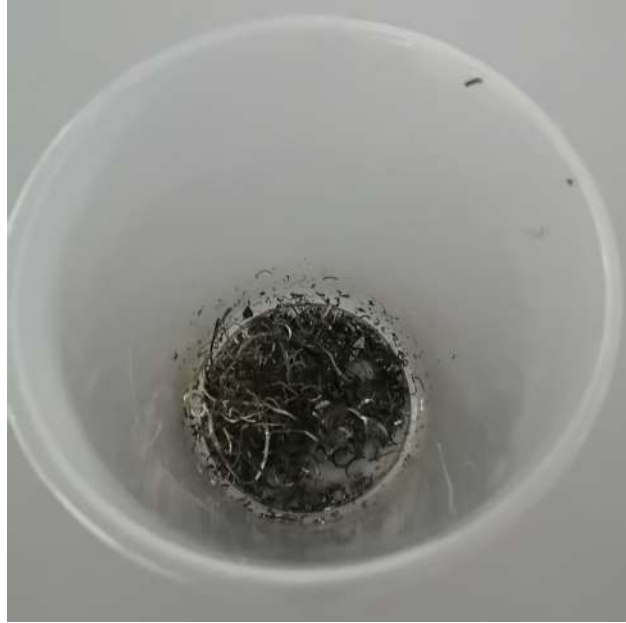
Figura 8.16. Muestra de rebaba para prueba en probeta.
