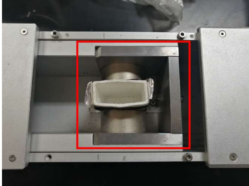
Figura 8.10. Soporte aislado para posición de sonda.
