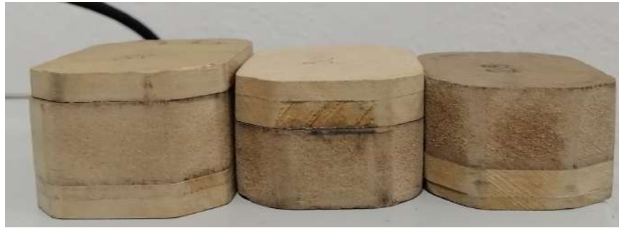
Figura 7.16. Aumentos de madera (32 mm, 30 mm y 28mm respectivamente).
