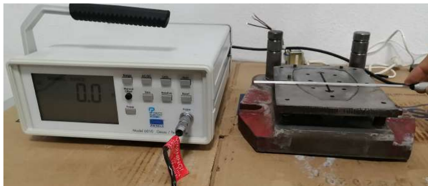
Figura 8.25. Lectura de campo magnético en parte superior después de desmagnetizar.
