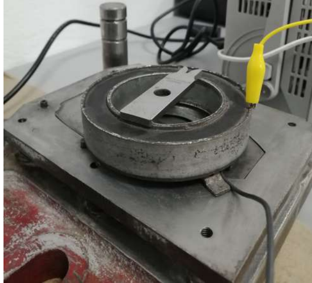
Figura 8.18. Desmagnetización de probeta de prueba.
