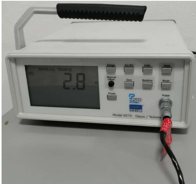
Figura 8.24. Lectura de campo magnético en parte inferior magnetizada.
