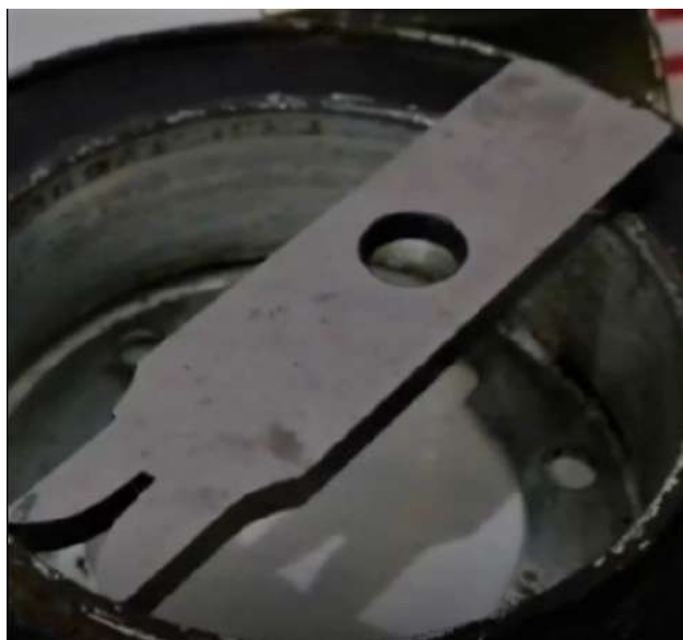
Figura 8.14. Probeta de prueba para magnetización y desmagnetización.
