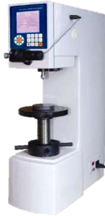
Figura 7.14. Medidor de dureza Brinell digital (foto extraída de TECHLABSYSTEMS).
