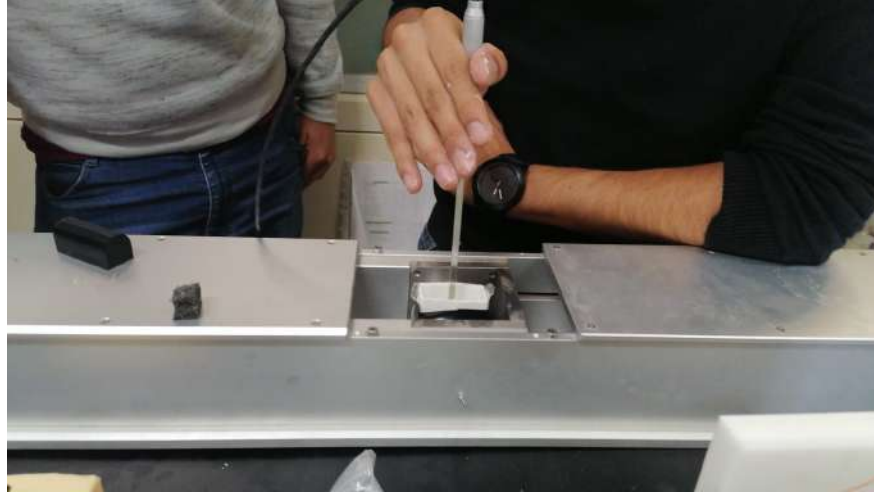
Figura 8.12. Manipulación de sonda axial en el campo magnético del sistema.
