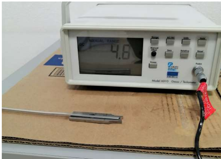
Figura 8.19. Medición de campo magnético de probeta después de la desmagnetización.
