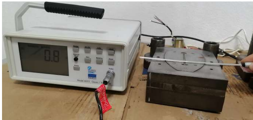
Figura 8.26. Lectura de campo magnético en parte inferior después de desmagnetizar.
