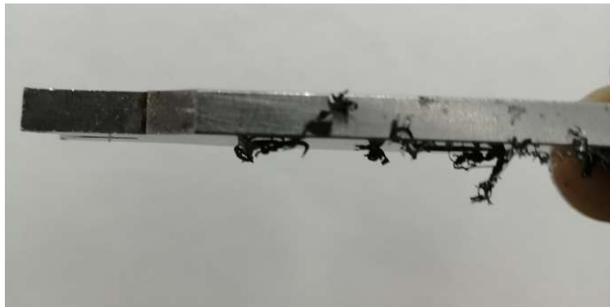
Figura 8.17. Probeta magnetizada con rebaba incrustada.
