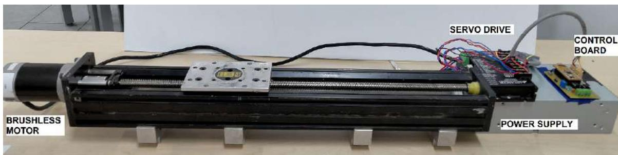
Figura 4.10: Plataforma lineal utilizada para la prueba del controlador
