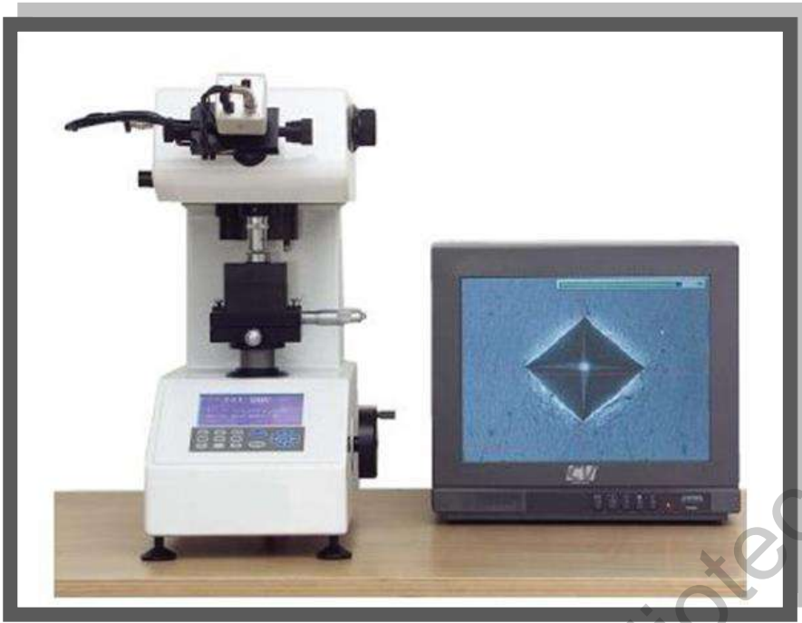
Figura 5. Microdurómetro Vickers CV400DM e imagen de indentación.
