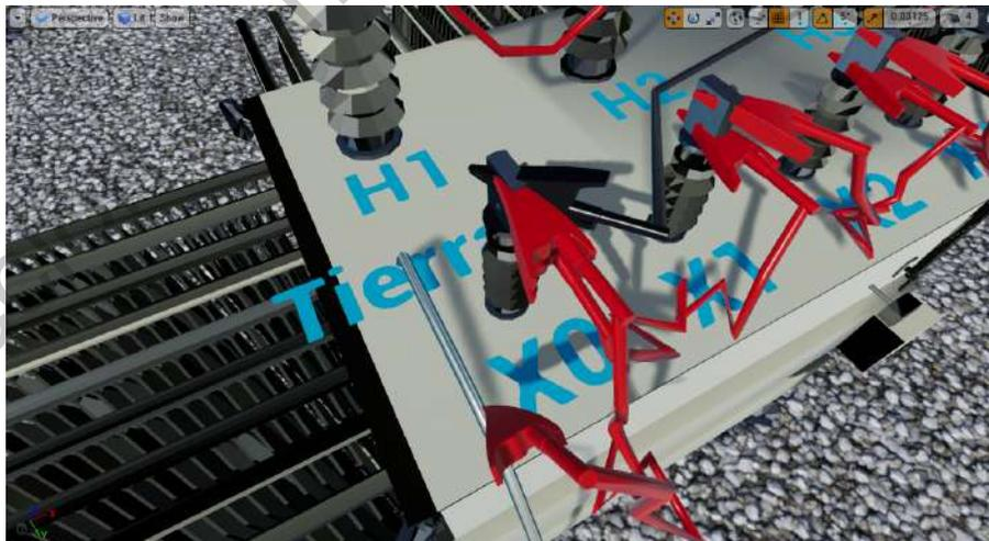
Figura 60: Colocación del puente auxiliar de la boquilla X0 a la tierra física (elaboración propia).
