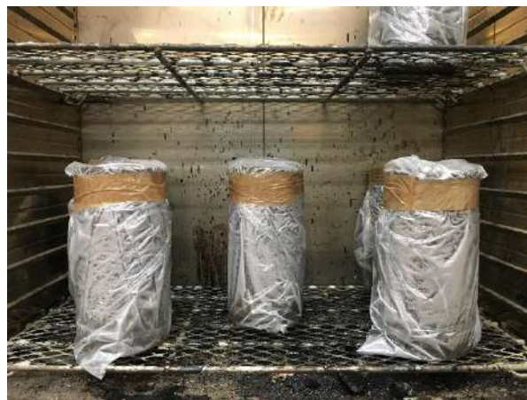
Imagen 15. Acondicionamiento de especímenes para ensaye Triaxial.
