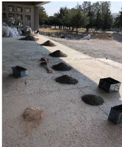
Imagen 4. Cuarteo de agregado en laboratorio.
