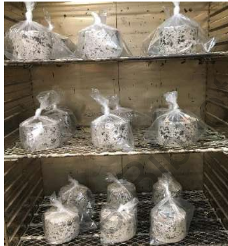
Imagen 13. Acondicionamiento de Espécimen en Horno.
