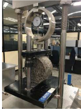
Imagen 12. Ensayo de Espécimen en Prensa Marshall.
