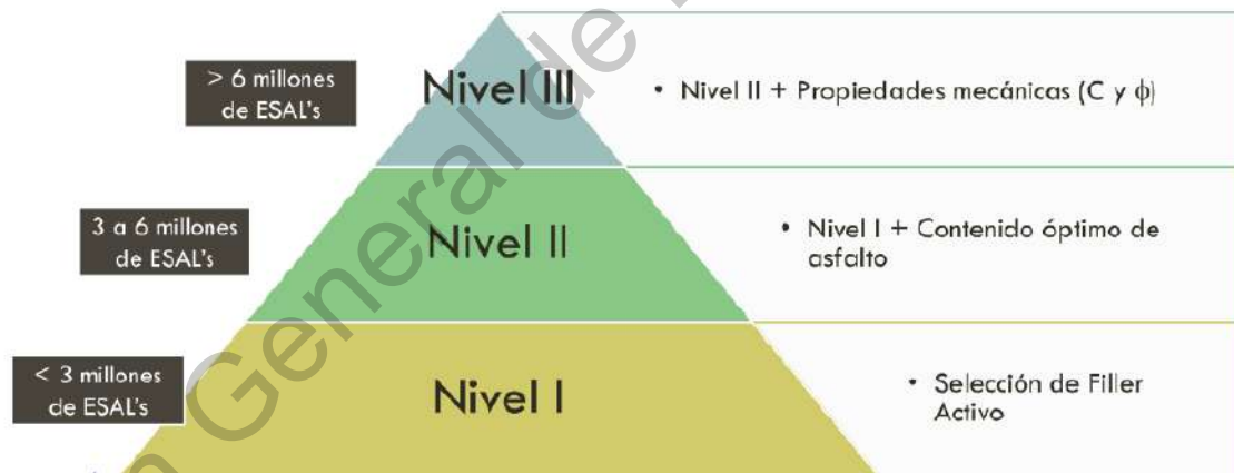
Figura 12. Niveles de diseño según el Método Wirtgen (Wirtgen GmbH, 2012).
