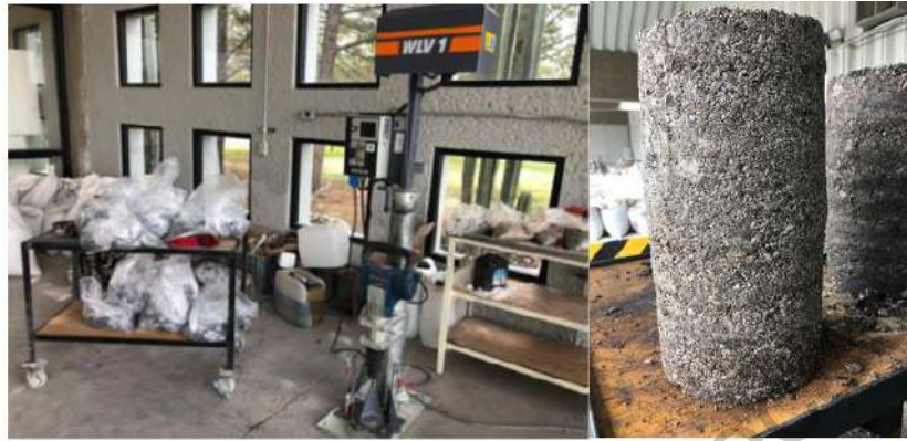
Imagen 14. Equipo para la compactación de especímenes de 30cm.
