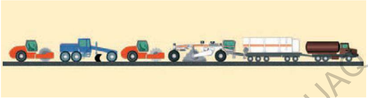
Imagen 2. Proceso de recuperación y pavimentación (Wirtgen GmbH, 2012).
