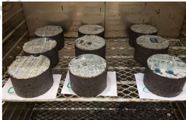
Imagen 11. Probetas para Ensaye Marshall.
