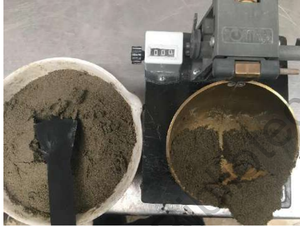
Imagen 5. Ensayo de plasticidad en agregado utilizado.
