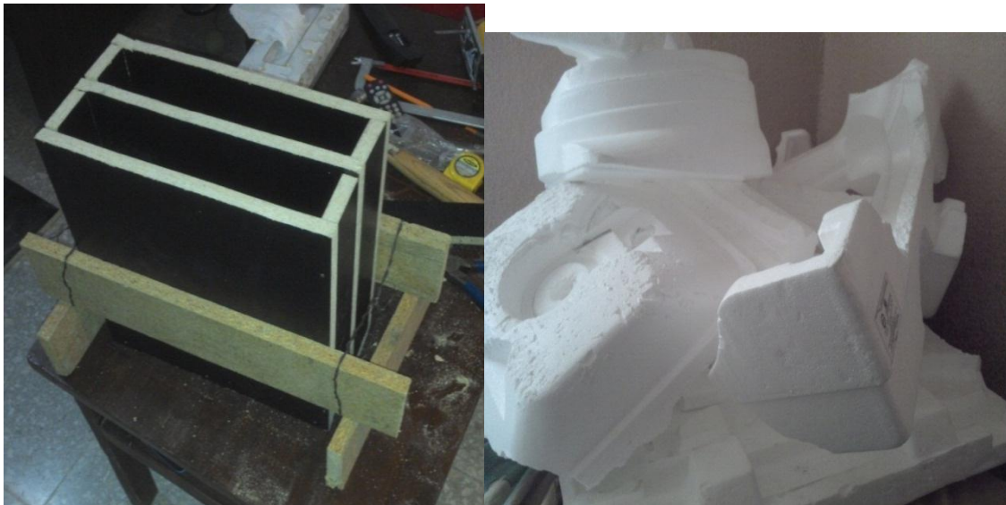
Figura 20 Producto de desecho de empresas de embalaje. Derecha molde para paneles de 30x30x5.5cm
