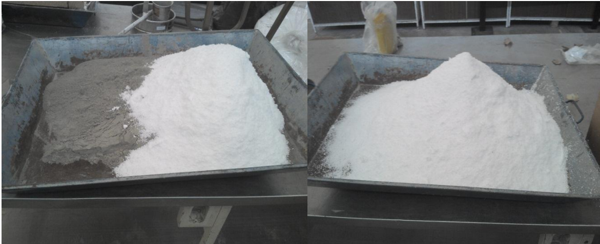
Figura 22 Material para elaborar paneles. Izquierda panel con 40% de EPS. Derecha panel de ferrocemento con 60% de EPS
