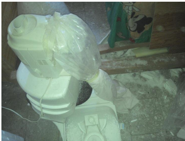
Figura 9 Triturado domestico con triturador en seco. La primera fase es el triturado, después el producto pasa por un conducto hasta un contenedor de almacenaje
