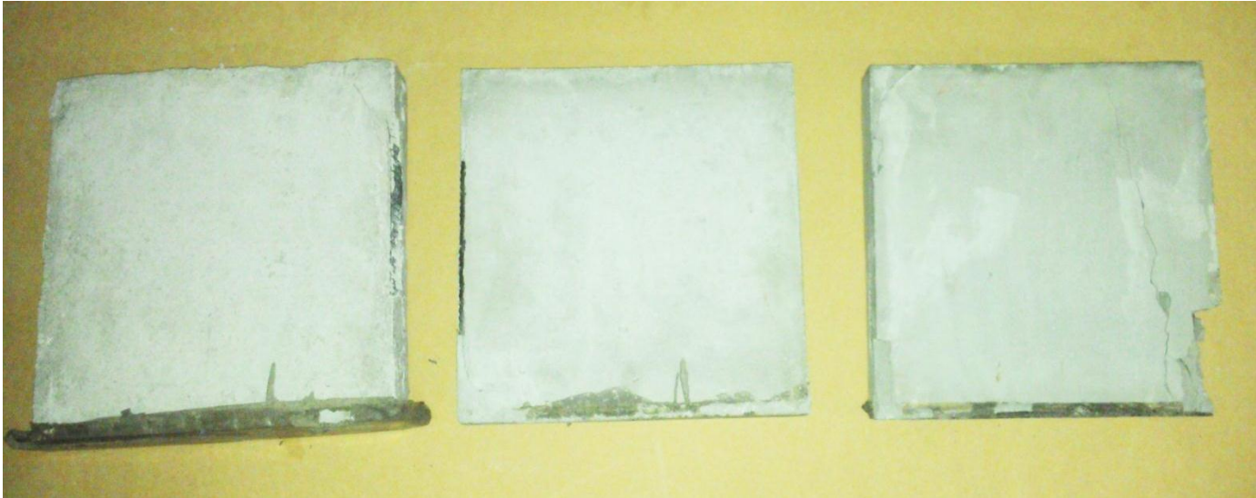
Figura 394 Fallas de paneles de ferrocemento por compresión simple, se aprecia la falla perimetral del armazón de acero. 0, 40 y 60% de derecha a izquierda
