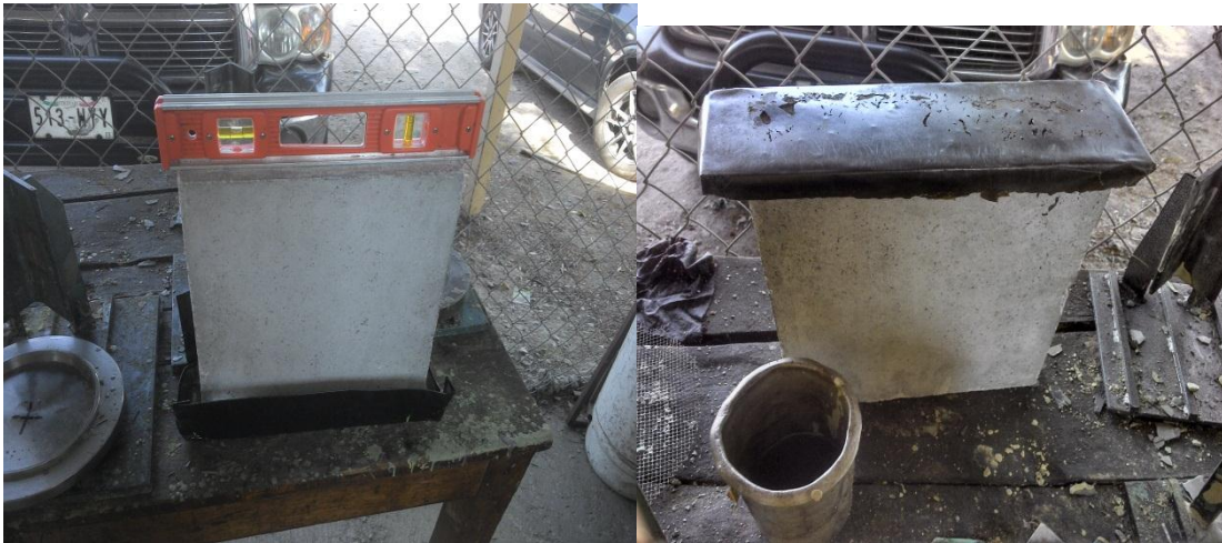
Figura 28 Izq. Nivelación de panel para el vertido de azufre líquido. Der. Panel cabeceado con azufre
