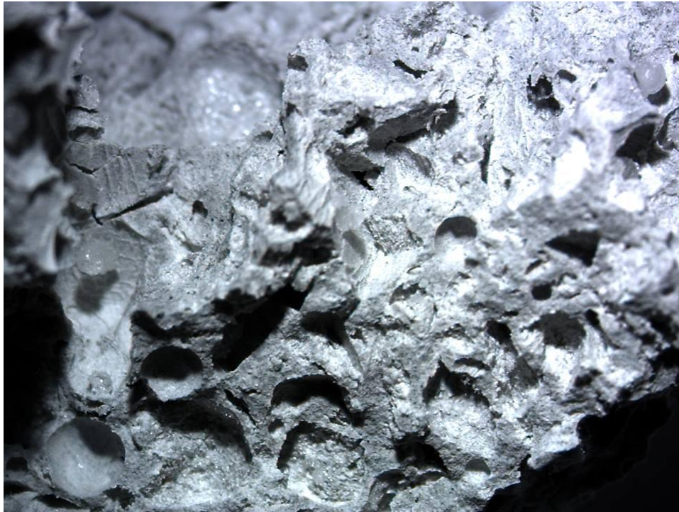
Figura 35 Micrografía de espécimen con 40% de sustitución de EPS después de haber sido sometido a 110°C durante 24hrs
