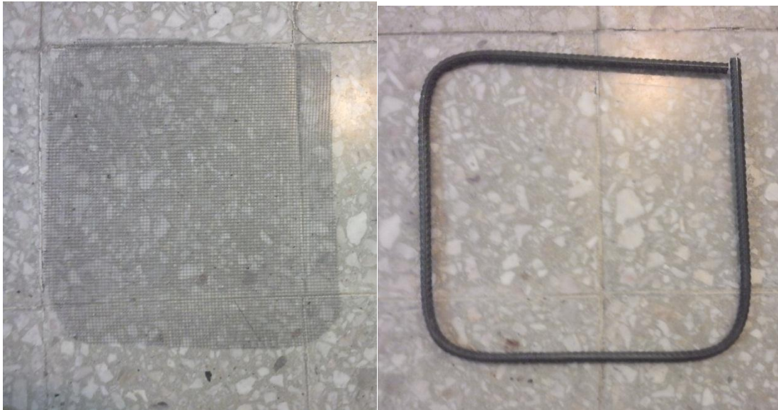
Figura 21 Izquierda malla de acero 8x8 recortada a la medida. Derecha armazón rígido para sostener la malla
