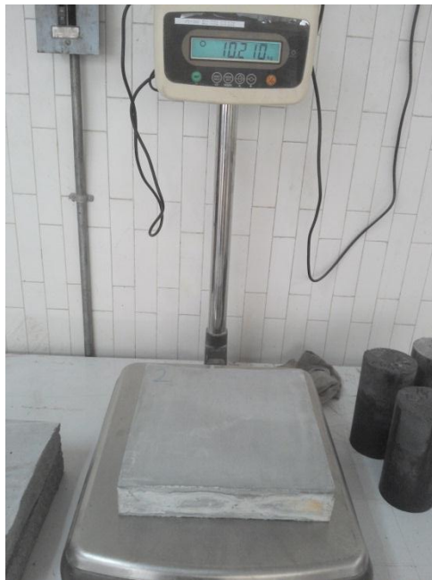
Figura 27 Pesaje de paneles ya curados de antes de la prueba de compresión.
