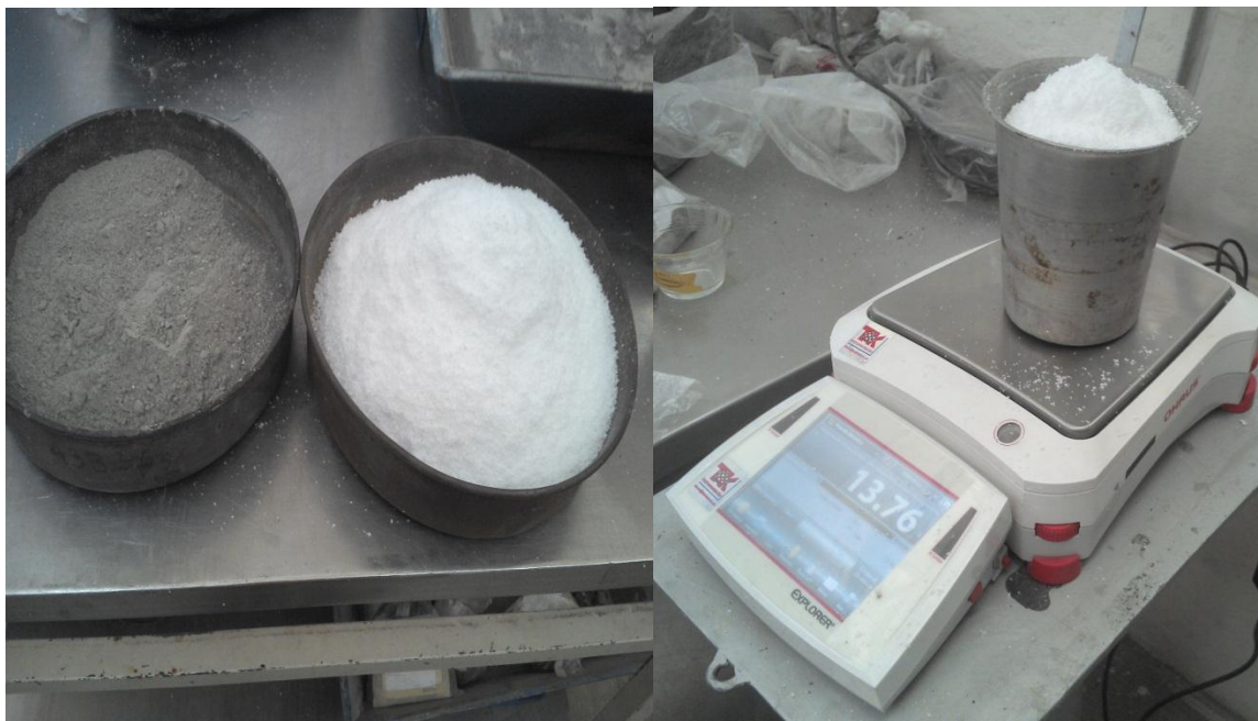
Figura 11 Materiales de preparación de mortero. Cemento y EPS a 20% de sustitución
