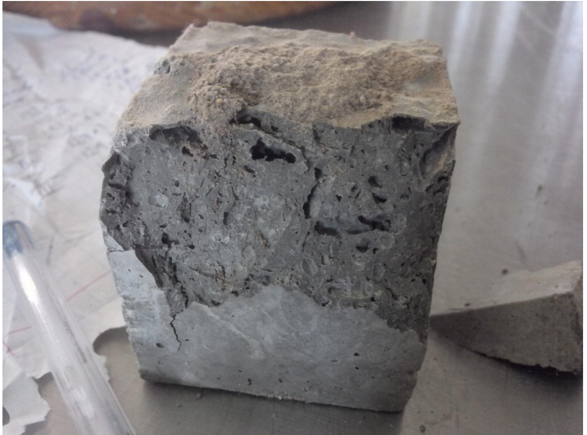
Figura 7 Fundición del EPS dentro del mortero por temperatura 110°C
