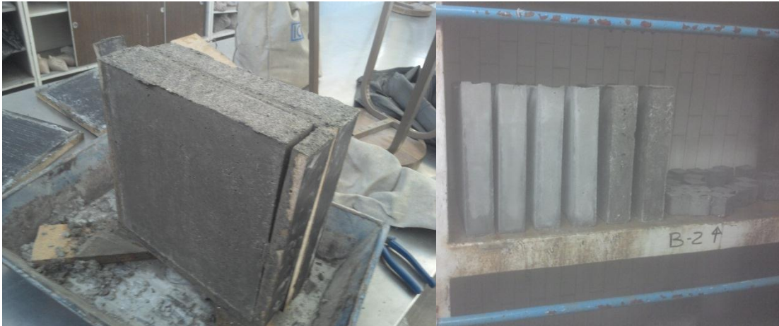
Figura 26 Desmoldado de paneles a partir del molde desarmable. Curado de paneles dentro de cuarto de curado
