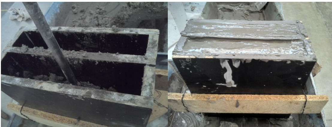
Figura 25 Compactación de mortero dentro de molde
