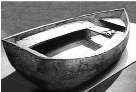
Figura 1 Bote de Joseph Lambot (3.66 x 1.22mts., 1855, ferrocemento, Paris).
