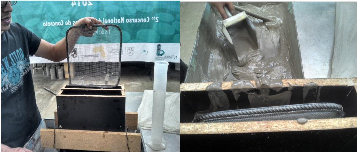
Figura 24 Colocación de malla de acero para panel. Vertido de mortero dentro de los moldes
