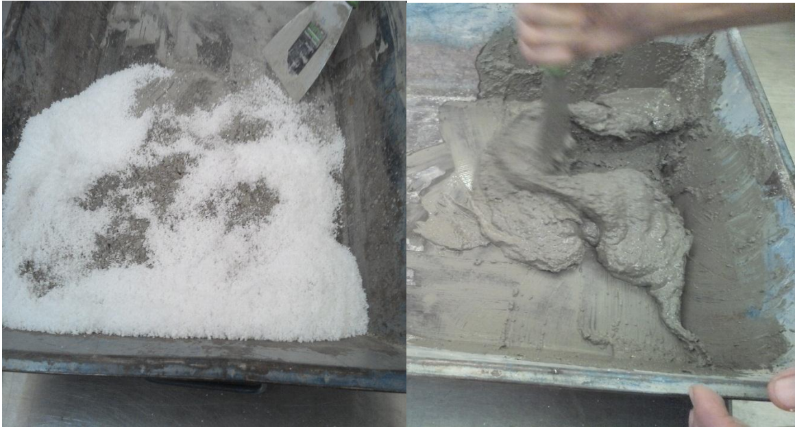
Figura 12 Izquierda: mezcla separada. Derecha Mezcla homogénea en el ya no se nota el EPS
