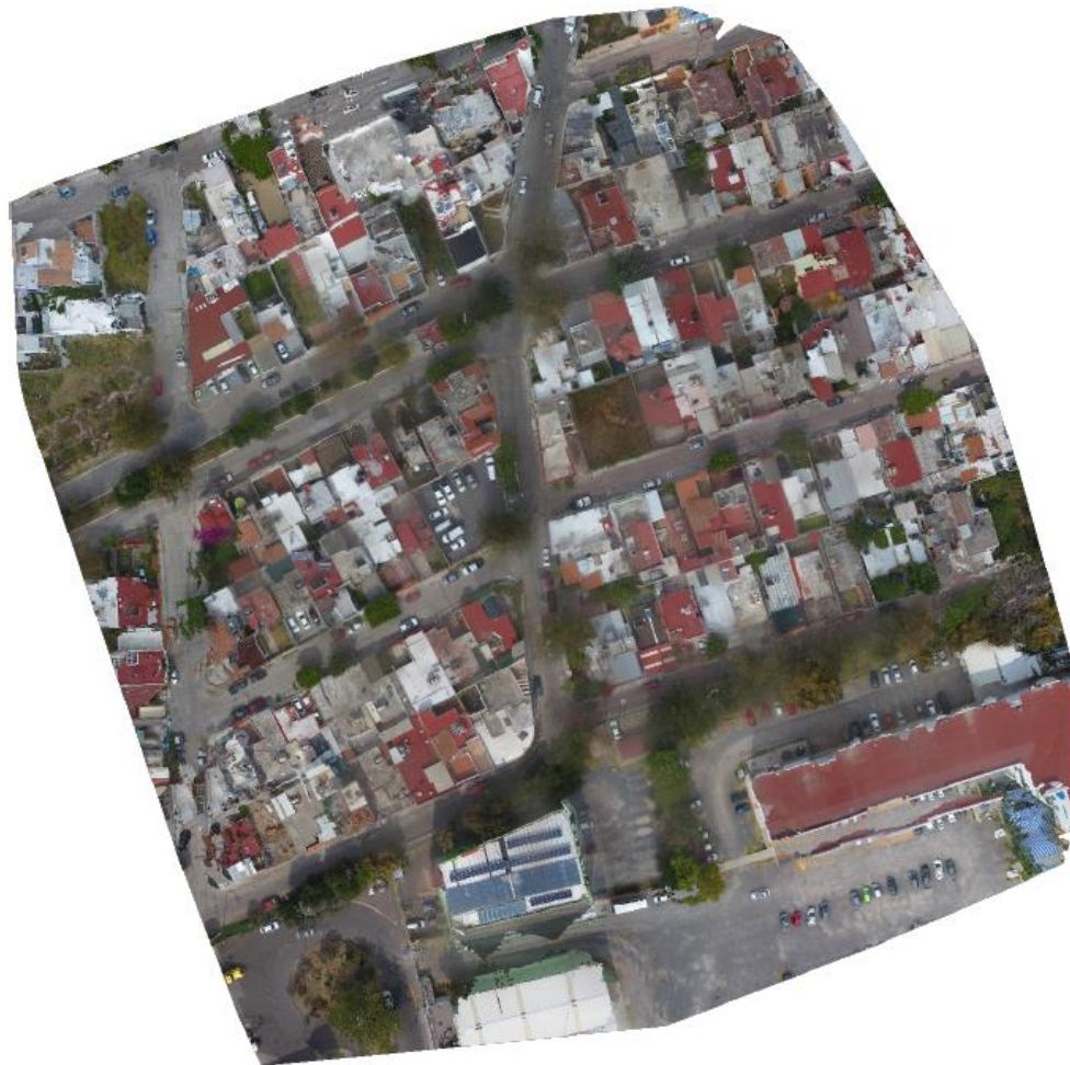
Figura 57. Ortomosaico obtenido con Pix4Dmapper de la medición 1. Elaboración propia (2020).
