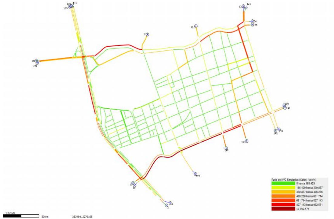
Figura 4.4. Flujo de automóviles en la simulación con el sistema enrutador de vehículos.
