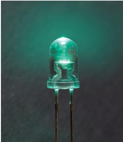
Figura 2.8. Chip semiconductor LED. Fuente: Revista Luminotecnia.
