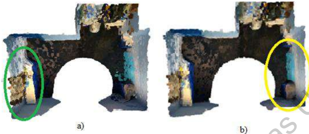
Fig. 4.31. Comparación de los resultados cualitativos entre ambos sistemas de reconstrucción 3D (vista superior). Modelo basado en métodos tradicionales (a), modelo basado en aprendizaje profundo (b).
