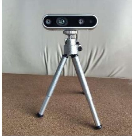
Fig. 3.3. Montaje de la cámara de profundidad para el muestreo de las nubes de puntos.
