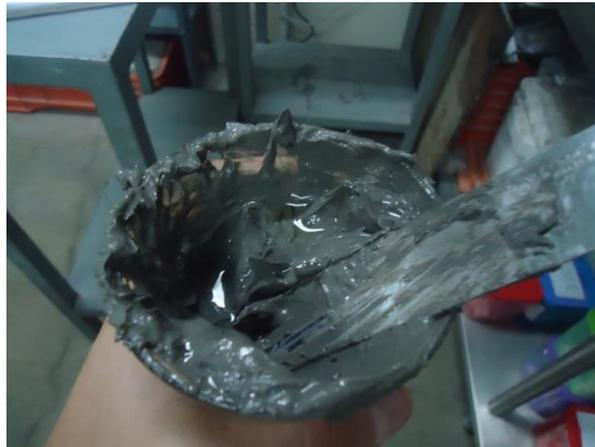
**Figura 4.6.** Separación de porciones para adición de agua requerida.
