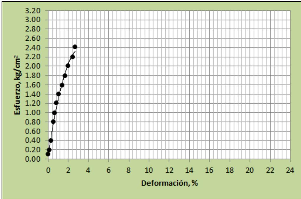
h) Gráfica esfuerzo-deformación de un suelo contaminado en un 30%. Presión confinante 1.0 kg/cm<sup>2</sup>
