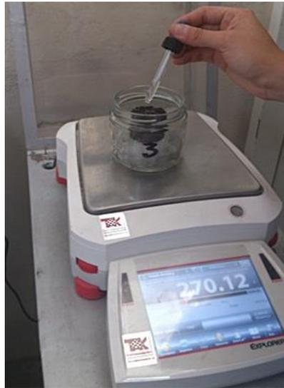
**Figura 4.3.** Cálculo de la cantidad máxima de diésel retenida por probeta.
