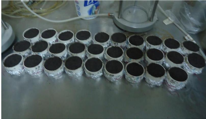
**Figura 4.2.** Probetas con material remoldeado para cálculo de succión.
