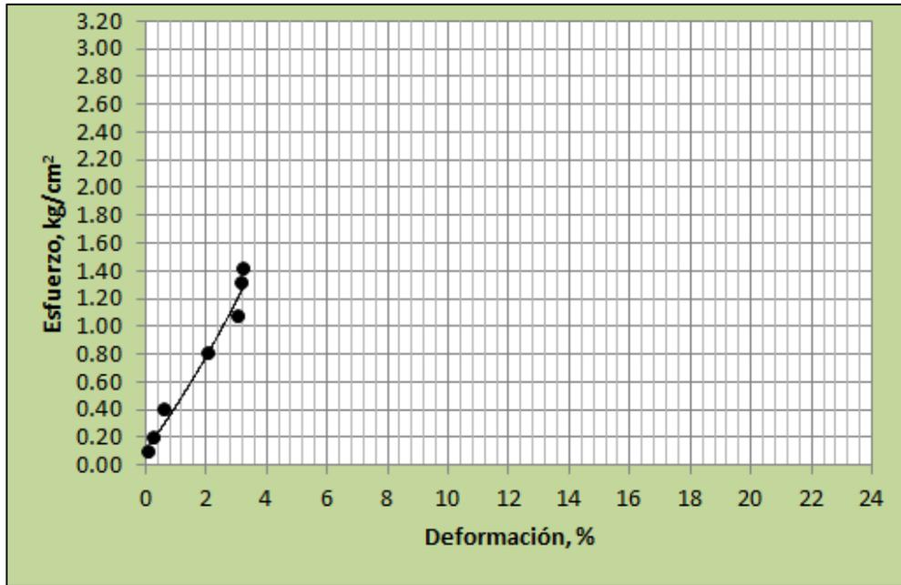
e) Gráfica esfuerzo-deformación de un suelo contaminado en un 20%. Presión confinante 0.5 kg/cm².
