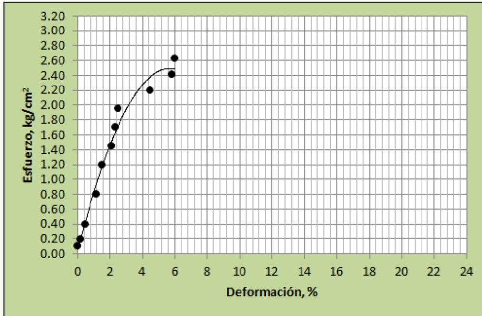
d) Gráfica esfuerzo-deformación de un suelo contaminado en un 10%. Presión confinante 1.0 kg/cm<sup>2</sup>
