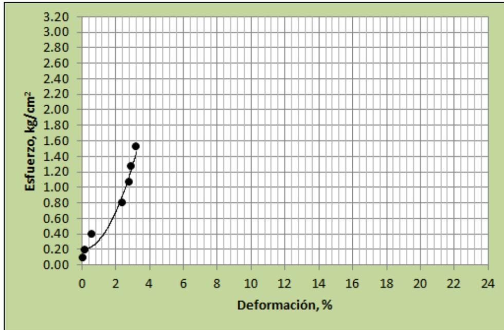
c) Gráfica esfuerzo-deformación de un suelo contaminado en un 10%. Presión confinante 0.5 kg/cm<sup>2</sup>
