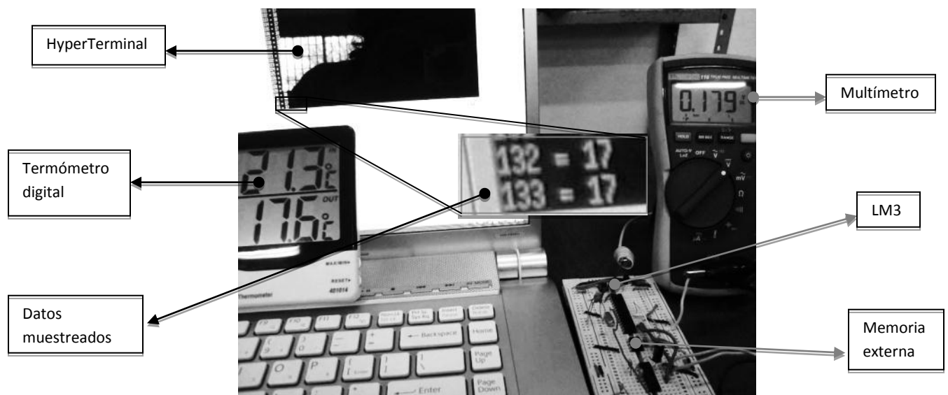
Fig.3. 2. Primeras pruebas y resultados con el LM35 en el CEDIT
