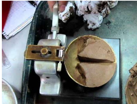
Figura 3.7 Método de la copa de Casagrande
