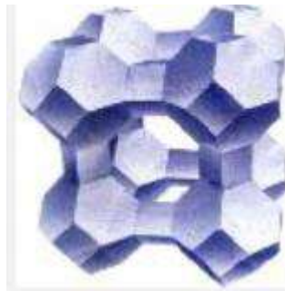
Figura 2.7 Estructura de una zeolita natural
