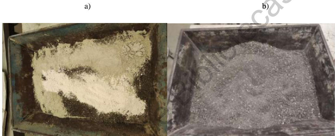
Figura 3.16 Dosificación y mezclado de suelo, cal y zeolita.
