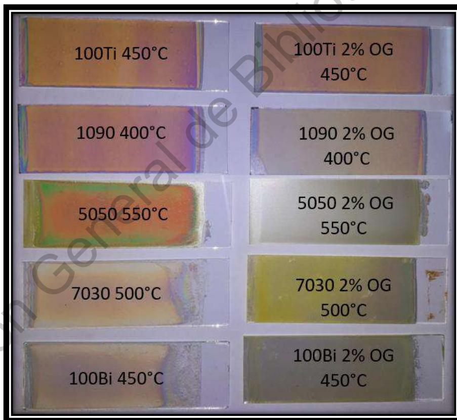
Figura 14. Apariencia física de las películas de \text{TiO}_2\text{-Bi}_2\text{O}_3\text{-OG} para cada una de las diferentes síntesis y temperaturas de sinterizado.
