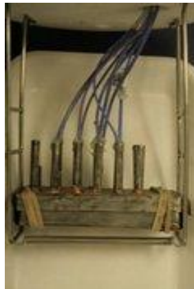
Figura 3.28. Colocación de termopares para determinación de difusividad térmica.
