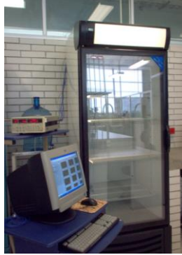
Figura 3.26. Cámara de congelación de convección forzada.
