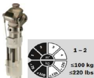
Figura 22. La 3R49 de Ottobock es una rodilla mecánica monocéntrica con frenado por postura, recomendada para grado de movilidad 1 y 2 y un peso máximo de 100kg. Tomadas de (Ottobock, 2020).
