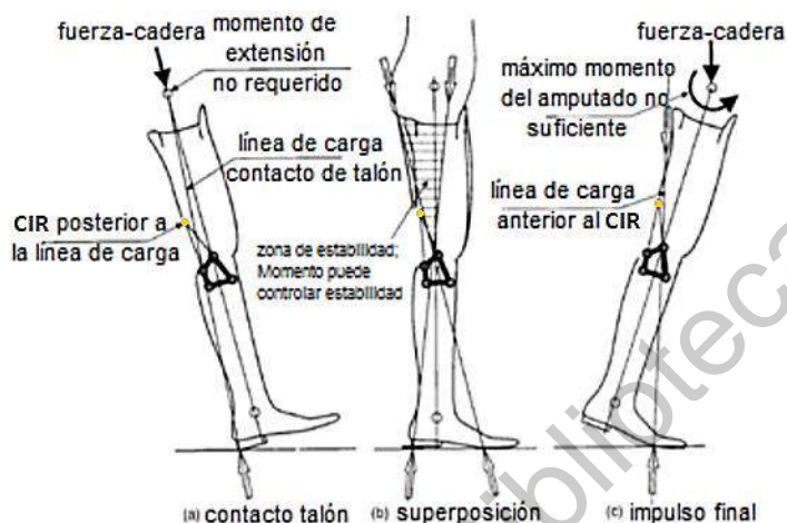
Figura 53. Mecanismo de cuatro barras hiper-estabilizado. Modificada de (Castro Valladares, 2012).
