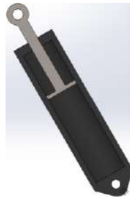
Figura 81. Vista de sección del amortiguador prueba.
