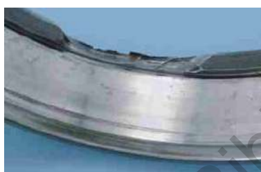
Figura 8.- Astilladura en la pista exterior en un rodamiento de rodillos cilíndricos (Koyo, 2019)
