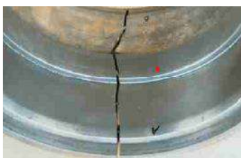
Figura 7.- Grietas en la pista exterior de un rodamiento de doble hilera de rodillos cilíndricos (Koyo, 2019)
